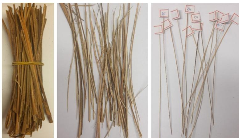
Figura 3.2 – Processo de desfibramento das fibras de ubim.
