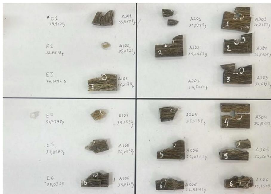
Figura 4.33 – Amostras após ensaio.
