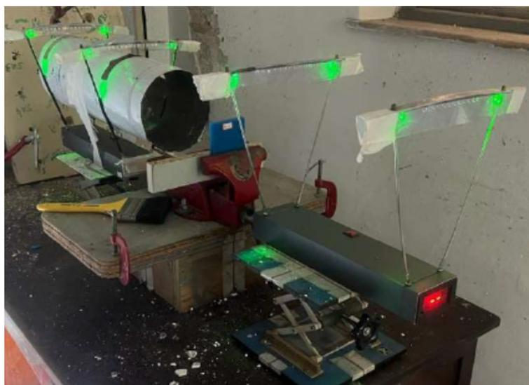
Figura 3.7 – mostra o sistema de detecção no ensaio de energia de absorção.
