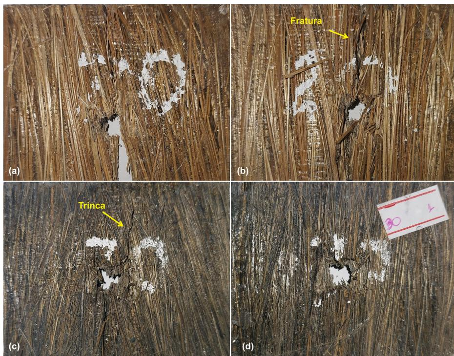
Figura 4.39 – Amostras perfuradas após ensaio de velocidade residual com projétil 7,62 mm. (a) e (b) 20%; (c) e (d) 30%.
