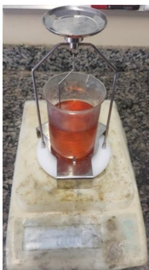
Figura 3.3 – Balança hidrostática utilizada para a determinação da densidade pelo princípio de Arquimedes.
