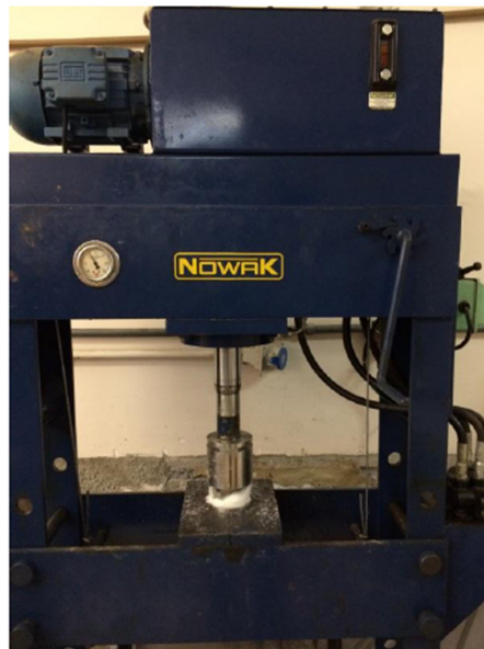
Figura 3.6 Prensa hidráulica semiautomática NOWAK, com capacidade para 30 toneladas.
