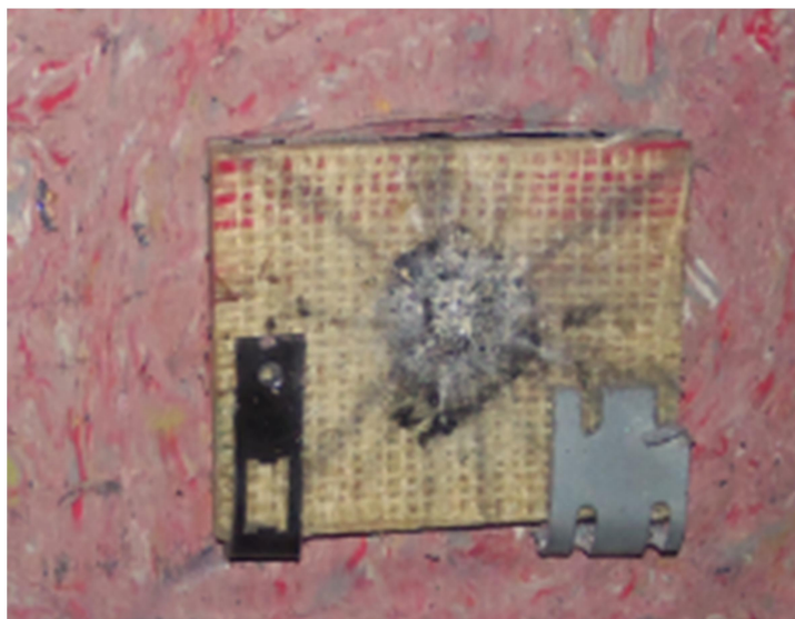
Figura 4.1 SBM após o disparo da munição de calibre 7,62 x 51 mm.
