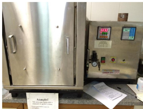
Figura 3.7 Forno INTI FE 1700, utilizado na sinterização das pastilhas cerâmicas.
