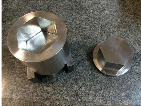
Figura 3.5 Matriz utilizada na moldagem dos corpos cerâmicos.
