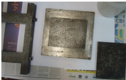
Figura 3.8 Matriz metálica utilizada na confecção das placas de compósito poliéster-fibra.
