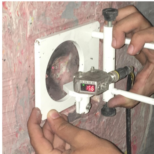
Figura 4.6 Medição da profundidade de indentação causada na plastilina após o ensaio balístico.
