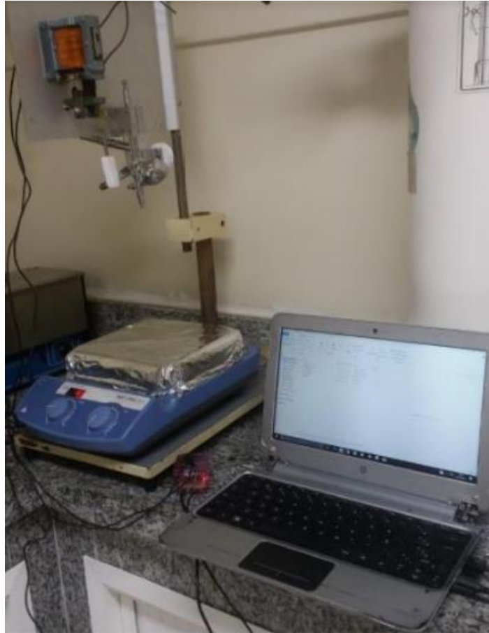
Figura 3.6 – Configuração do sistema de spray coating automatizado.
