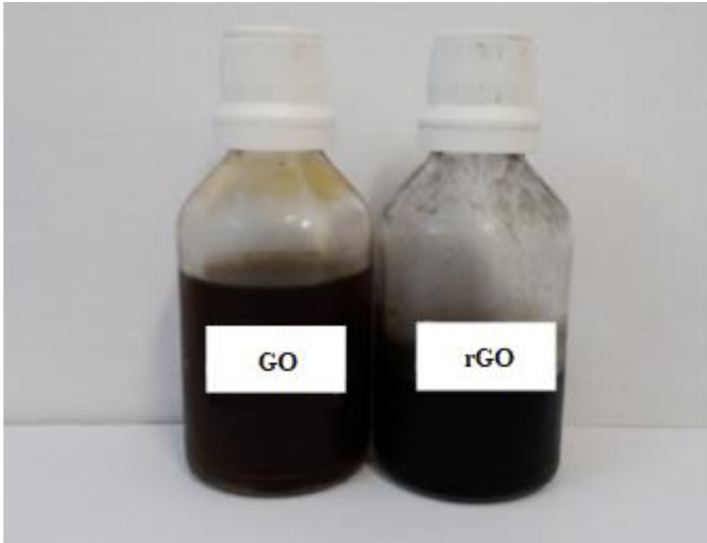
Figura 3.1 – Dispersões aquosas obtidas nas produções de GO e rGO.
