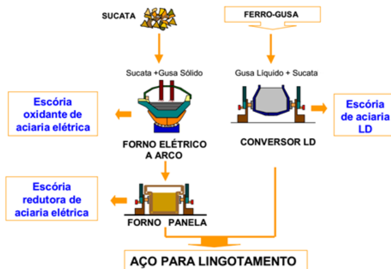
FIG.2.8 Representação esquemática do processo de refino do aço, com suas respectivas etapas de geração de escórias (Adaptado de Masuero et al., 2004)
