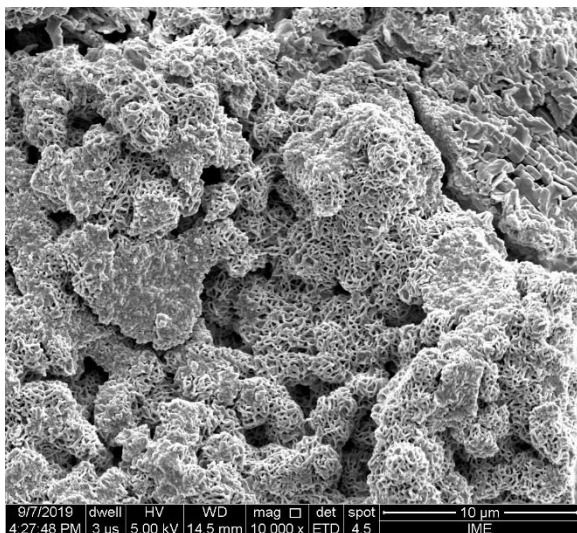
FIG.4.27 Micrografias de SEM dos geopolímeros NPCT nas proporções 1,2 (a), 1,4 (b) e 1,6 g/v (c)
