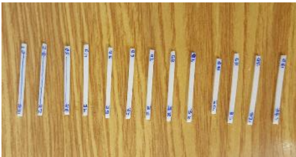
FIG 4.7 Parte dos corpos de prova da zircônia 3YSB-E sinterizados e com marcação para ensaio de flexão.
