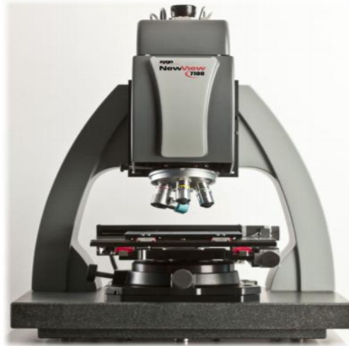
FIG 4.11 Rugosímetro por interferometria óptica Zygo NewView 7100 (Zygo Corporation, Connecticut, Estados Unidos). Fonte: http://www.lao.cz/data/ke-stazeni/datasheet-7100-d834.pdf
