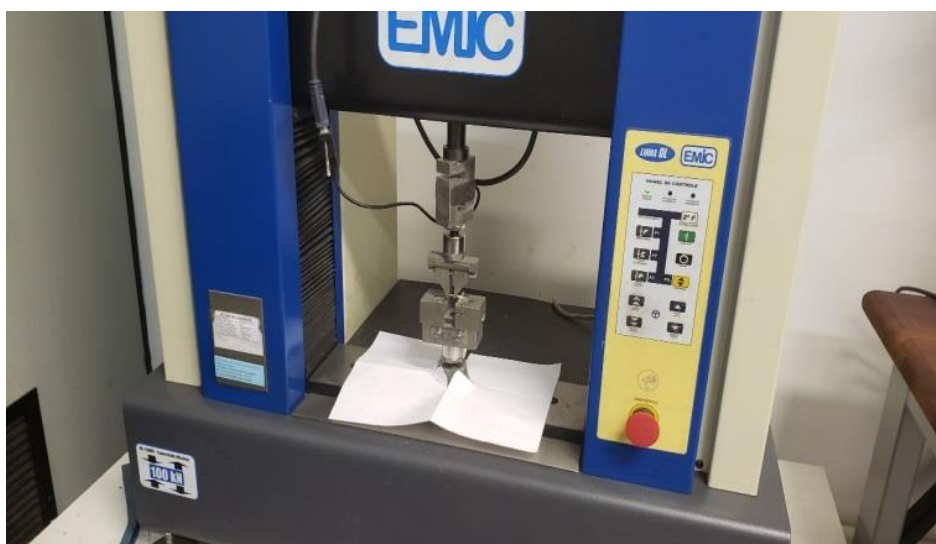
FIG 4.8 Ensaio de flexão em quatro pontos realizado na máquina universal de ensaios EMIC modelo DL-10000 (EMIC Equipamentos e Sistemas de Ensaio LTDA, São José dos Pinhais, PR, Brasil).
