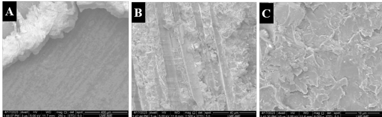
Figura 50 – Morfologia da superfície das amostras do grupo PE após o ensaio de cisalhamento. Aumento: (a) 250 x, (b) 2500x, (c) 8000 x.
