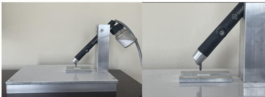
Figura 9 – Dispositivo desenvolvido, em operação de jateamento de óxido de alumínio na zircônia. Fonte: Autor (2023).
