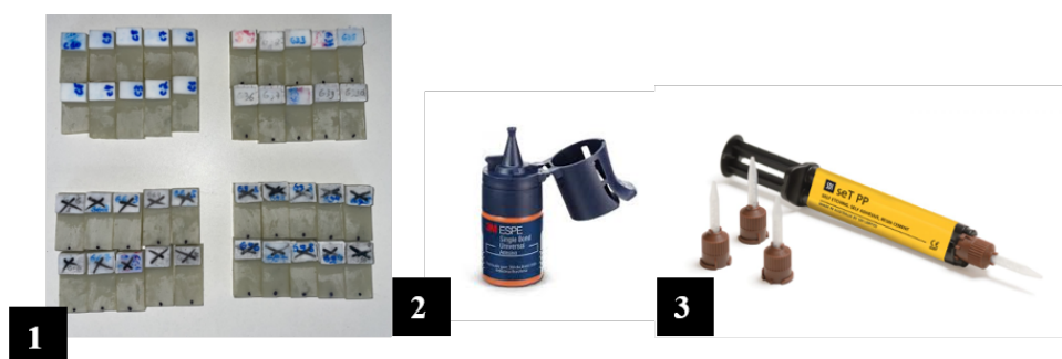
Figura 11 – Amostra de NG-10® cimentados na zircônia revestida por tinta epóxi e poliéster (1). Feito pinclamento de adesivo Single Bond Universal (2) no NG-10® e nesses revestimentos de tintas pintados na zircônia. A cimentação foi feita com cimento resinoso seT PP (3). Fonte: Autor (2023).
