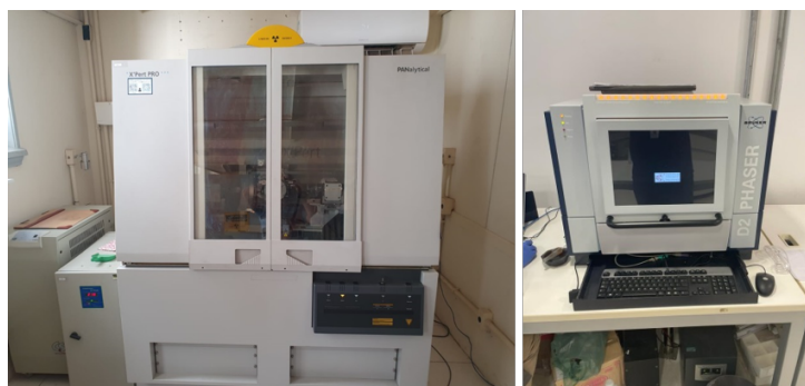
Figura 12 – Difratômetros de raios X utilizados nas caracterizações cristalográficas. Fonte: Autor (2023).
