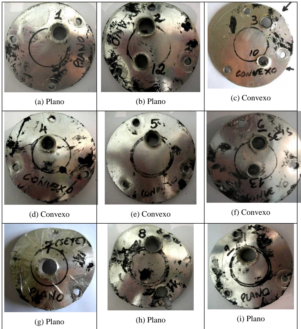
FIG 4.28 Superfícies do confinamento frontal dos alvos utilizados. A letra (a) corresponde ao impacto 1 e sequencialmente até que a letra (i) corresponde ao impacto 9 da TAB 4.24.
