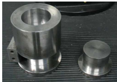
FIG 3.3 Matrizes metálicas para confecção de CP's.
