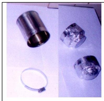
FIG 3.16 Montagem do confinamento em recipiente metálico.
