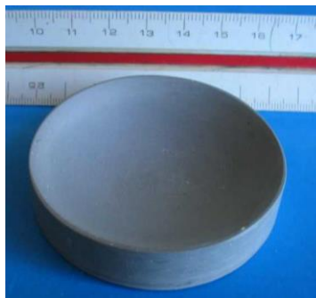
FIG 3.4 Matriz para obtenção da superfície convexa.
