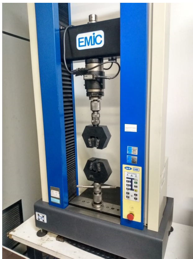
Figura 49 – Máquina universal de ensaios mecânicos, marca EMIC, modelo DL-10000.
