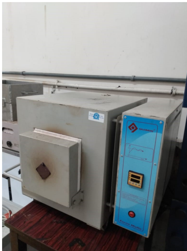
Figura 36 – Forno do tipo mufla modelo Quimis Q-138-M-24 para realização do tratamento de recozimento do material deste estudo.
