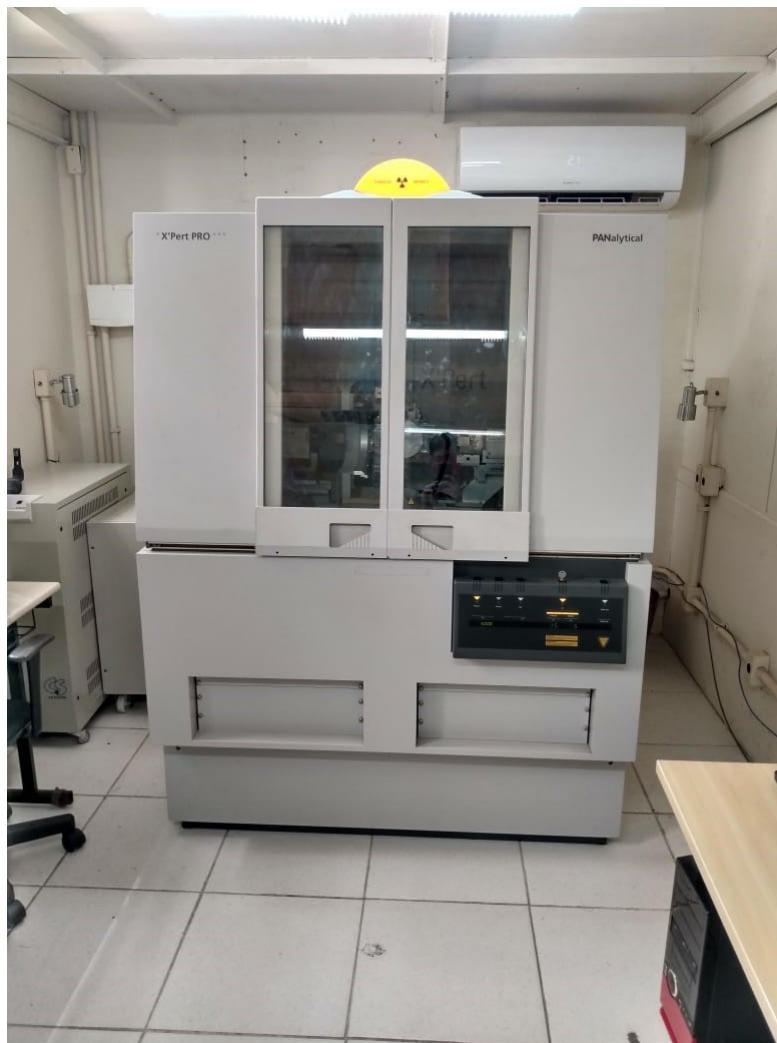
Figura 39 – Difratorômetro de Raios X, modelo X'PERT PRO MRD da PANalytical.
