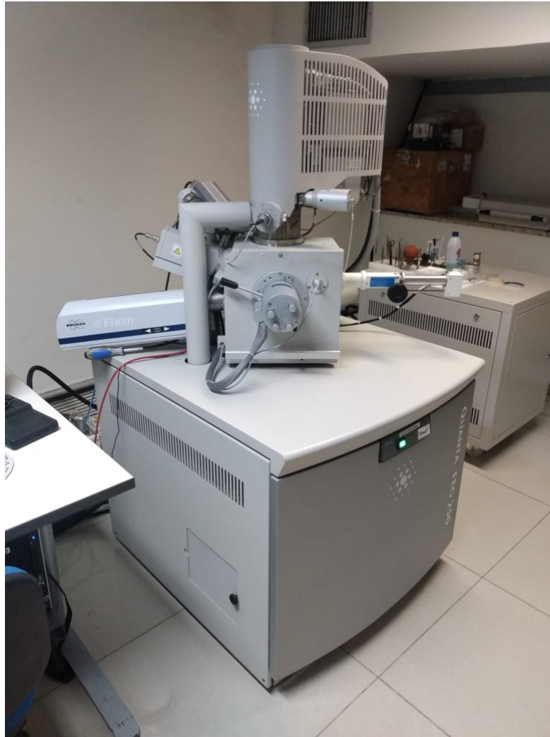
Figura 41 – Microscópio eletrônico de varredura modelo QUANTA 250 FEG – FEI
