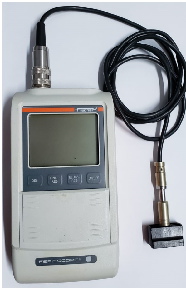
Figura 37 – Ferritoscópio FISCHER - FMP30 para a quantificação de martensita no material deste estudo.
