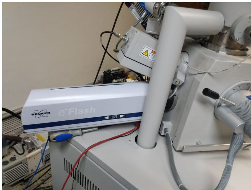
Figura 43 – Detector Bruker para análise de EBSD do presente estudo.
