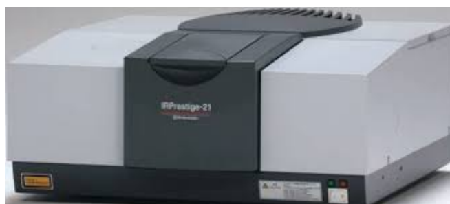
Figura 3.10 - Espectrômetro de infravermelho com transformada de Fourier (FTIR) em um modelo IR PRESTIGE 21-FTIR da SHIMADZU (Disponível em: < http://shim-pol.pl >).
