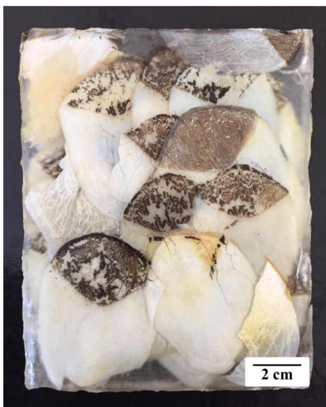
Figura 3.5 - Placa do material compósito com reforço de 30%v/v de escamas de pirarucu.
