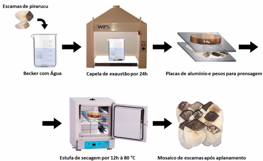
Figura 3.2 - Processo de aplanamento das escamas de pirarucu.
