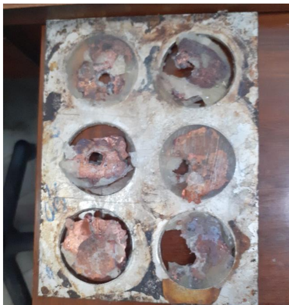
Figura 4.4 – Amostra 30 %v de compósito poroso na resina epóxi.
