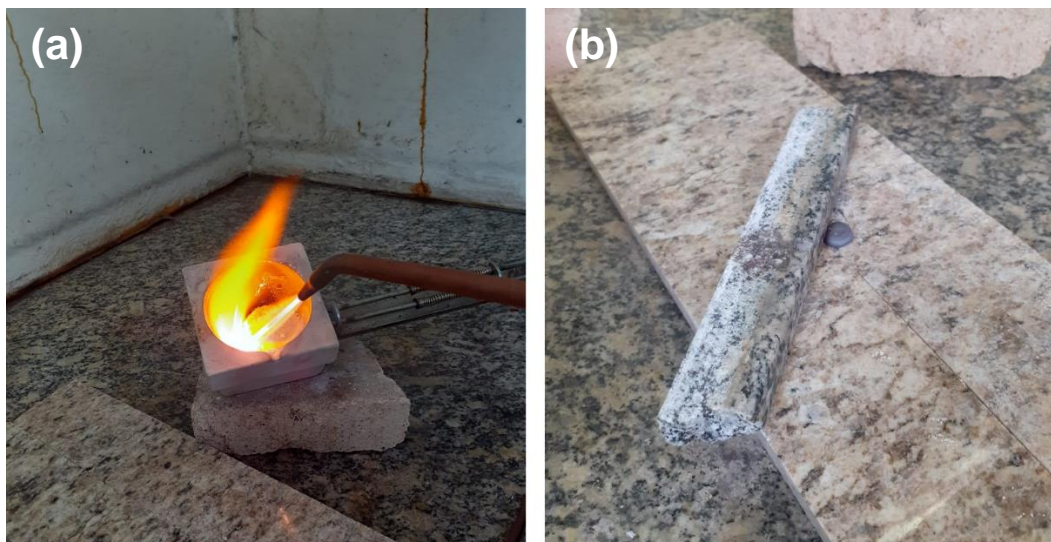
Figura 3.1 – (a) Cadinho contendo o conjunto Cu+PE sob aquecimento; (b) Placas cerâmicas de granito empregadas para prensar o fundido.
