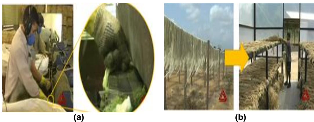
Figura 2.10 - Processos de obtenção da fibra de curauá. a) desfibramento da folha; b) secagem ao ar e em estufa após mercerização e lavagem (PEMATEC, 2005)
