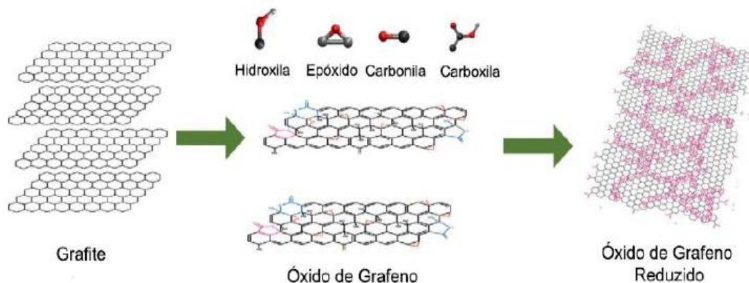
Figura 2.15 - Rota de síntese do GO (adaptado de Bonaccorso et al. , 2012)
