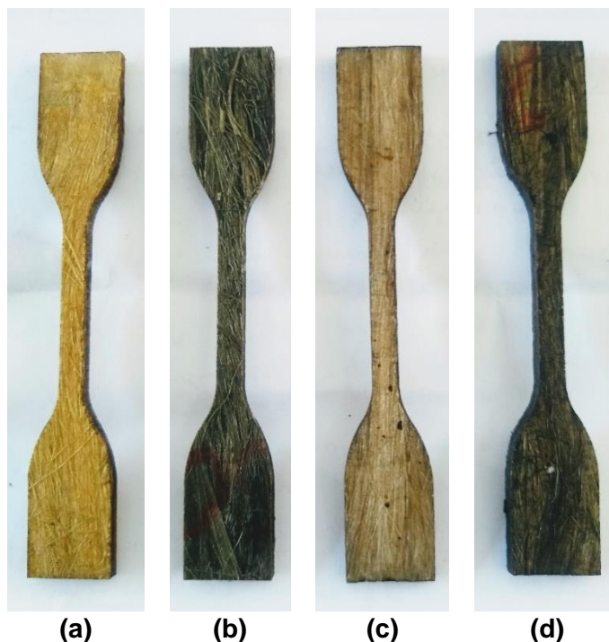
Figura 3.19 – Corpos de prova dos compostos para ensaio de tração: a) FC/E; b) FCGO/E; c) FC/EGO e d) FCGO/EGO.
