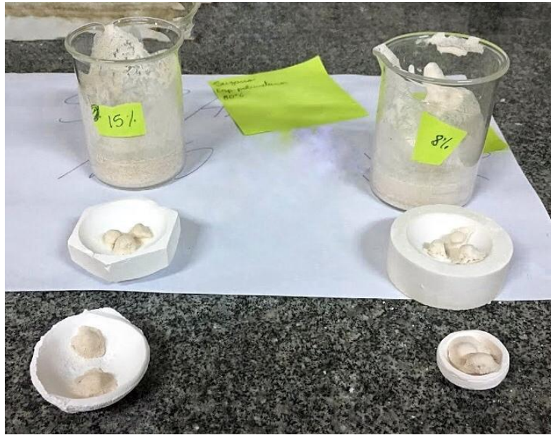
FIG. 3.5 Amostras de esponjas poliméricas recobertas com a pasta cerâmica.
