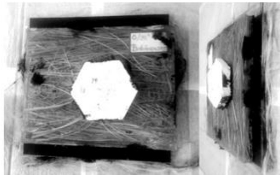
FIG. 3.9 – Amostra do sistema de blindagem multicamadas antes do ensaio de indentação na plastilina.
