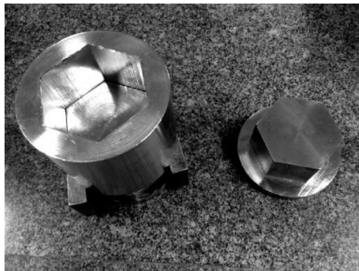
FIG 3.6 – Punção e camisa para a prensagem dos cerâmicos.
