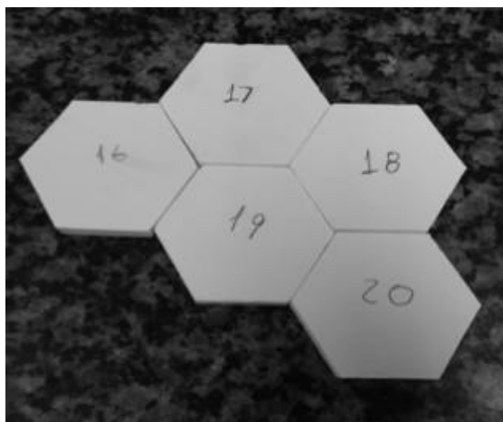
FIG. 3.11 – Pastilhas cerâmicas ( \text{Al}_2\text{O}_3+\text{Nb}_2\text{O}_3 ) após a sinterização.
