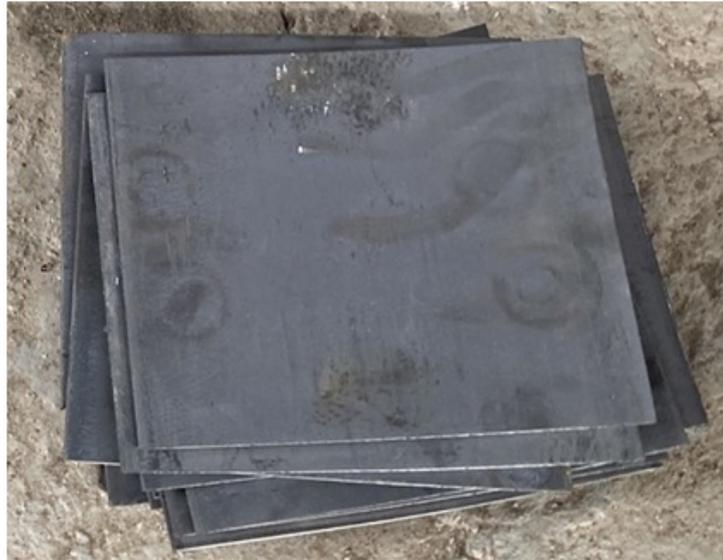
Figura 23 – Chapas cortadas nas dimensões aproximadas de 200 mm x 200 mm x 4 mm.
