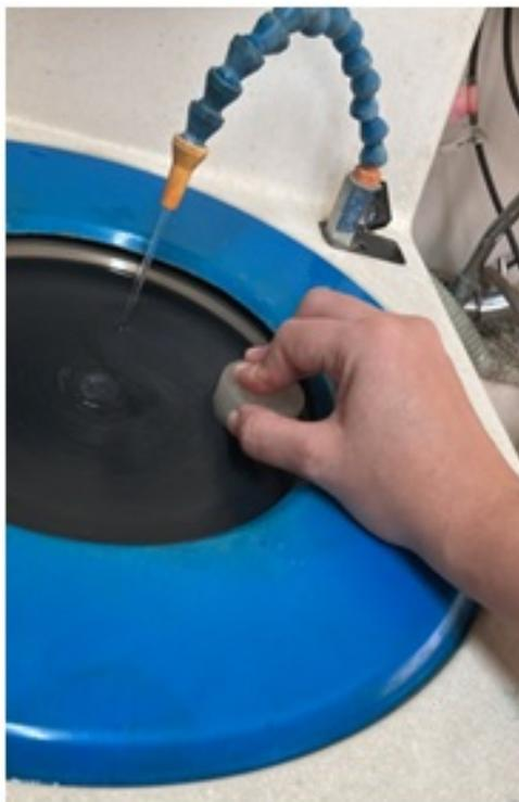
Figura 40 – Lixamento das amostras embutidas.
