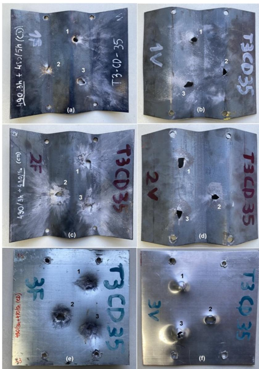
Figura 73 – Amostra T3-CD-35: Faces frontal (a) e distal (b) da 1ª camada; frontal (c) e distal (d) da 2ª camada; e frontal (e) e (f) distal da placa testemunho
