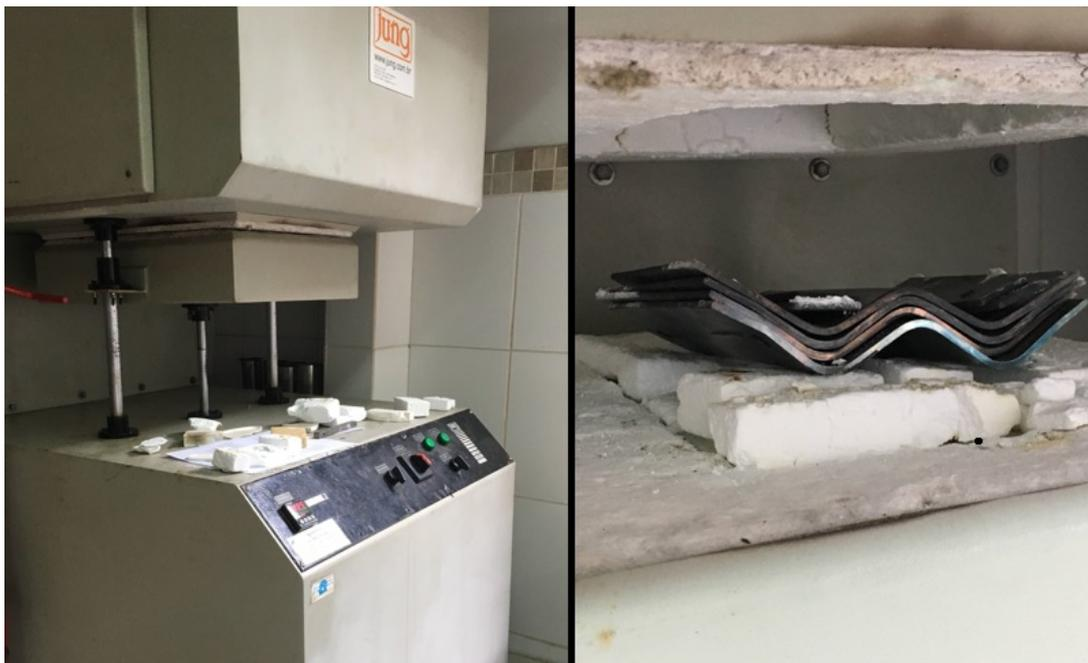
Figura 26 – Forno modelo LF0914 da marca Jung, do IME, e amostras de aço maraging após aquecimento.
