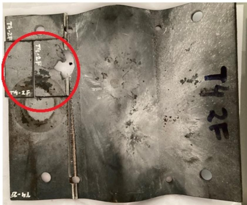
Figura 37 – Segunda camada do corpo-de-prova T4, do 1º ensaio balístico, cortada (em destaque no canto superior esquerdo: amostra para análise de dureza, à esquerda, e análise de fratura em MEV, à direita).
