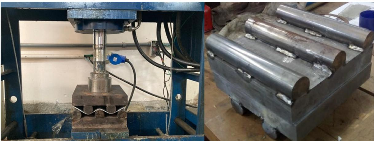
Figura 24 – (a) Prensa Nowak do IME; e (b) matriz utilizada (CUNHA, 2019).
