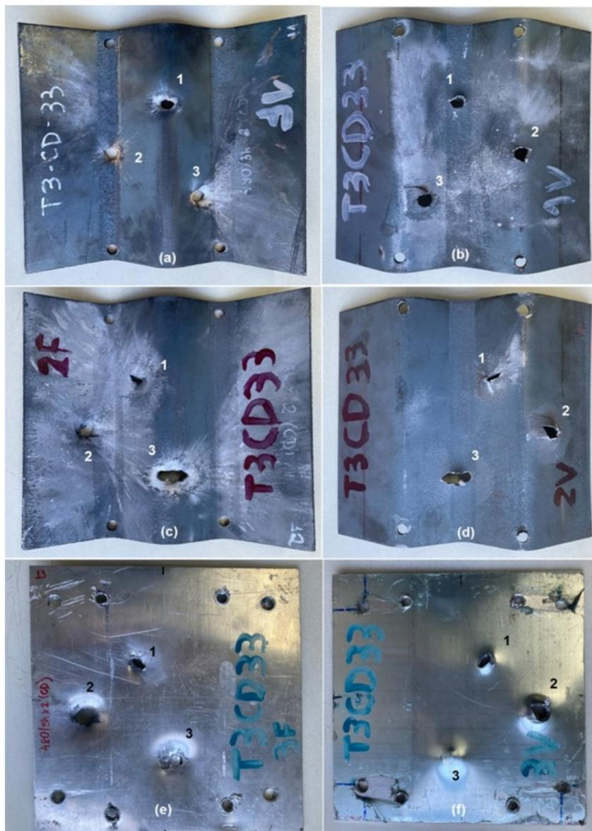
Figura 75 – Amostra T3-CD-33: Faces frontal (a) e distal (b) da 1ª camada; frontal (c) e distal (d) da 2ª camada; e frontal (e) e (f) distal da placa testemunho
