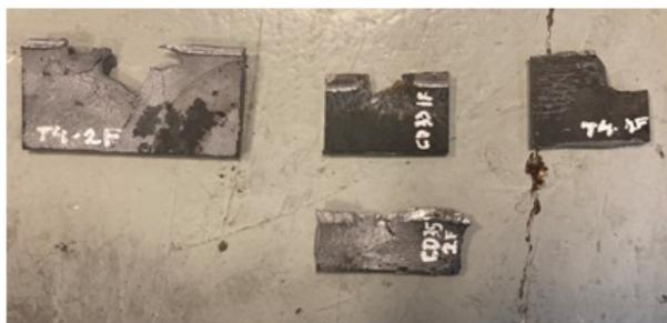
Figura 42 – Amostras para análise da superfície de fratura em regiões de impacto, referentes aos dois ensaios balísticos.
