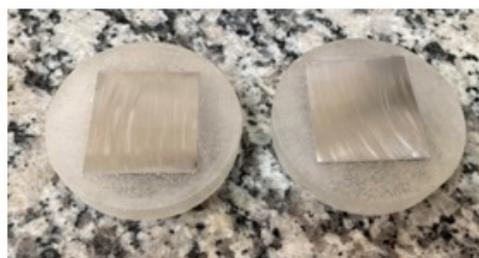
Figura 44 – Amostras utilizadas no ensaio de dureza.
