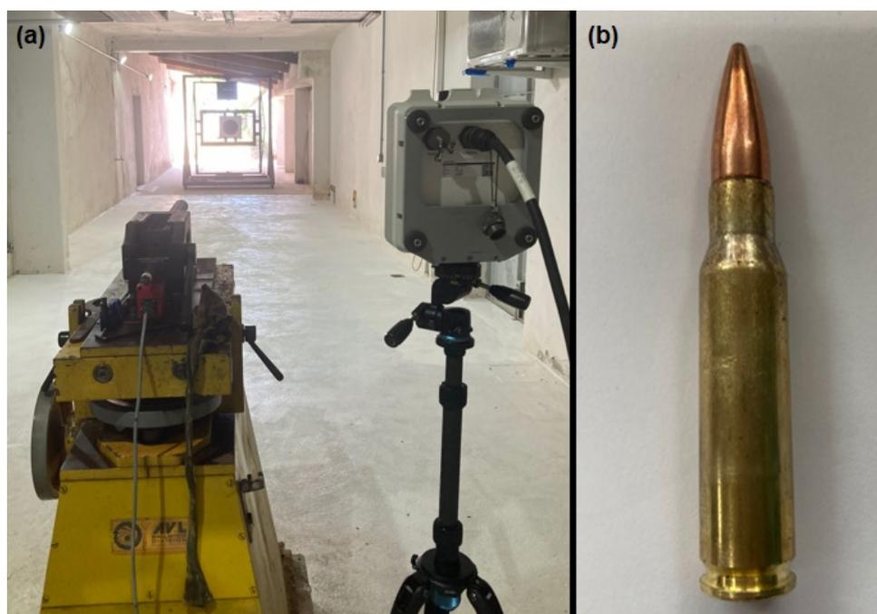
Figura 29 – (a) Equipamento; e (b) munição 7,62x51 mm FMJ utilizados nos ensaios balísticos.
