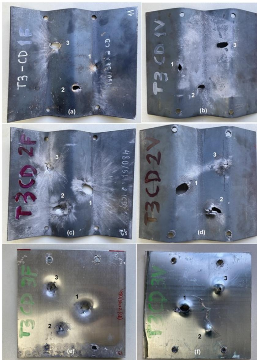
Figura 71 – Amostra T3-CD: Faces frontal (a) e distal (b) da 1<sup>a</sup> camada; frontal (c) e distal (d) da 2<sup>a</sup> camada; e frontal (e) e (f) distal da placa testemunho
