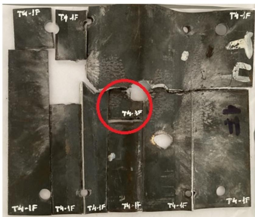
Figura 36 – Primeira camada do corpo-de-prova T4, do 1º ensaio balístico, cortada (em destaque no meio: amostra para análise de fratura em MEV).
