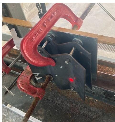
Figura 30 – Fixação da amostra no suporte de alvos e o feixe de laser para direcionamento do impacto.
