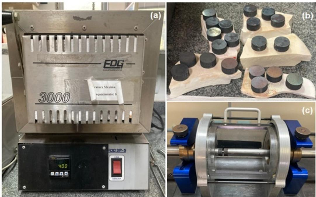
Figura 48 – (a) Forno empregado no tratamento dos inserts; (b) inserts após tratamento térmico; e (c) posicionamento dos inserts e amostra no momento do teste.
