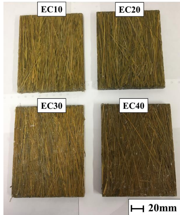
Figura 3.12 Placas compósitas produzidas nas frações de 10, 20, 30 e 40% em volume de fibras de carnaúba.
