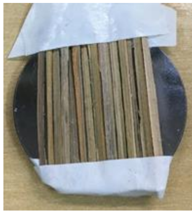
Figura 3.9 Amostra montada para análise de DRX.
