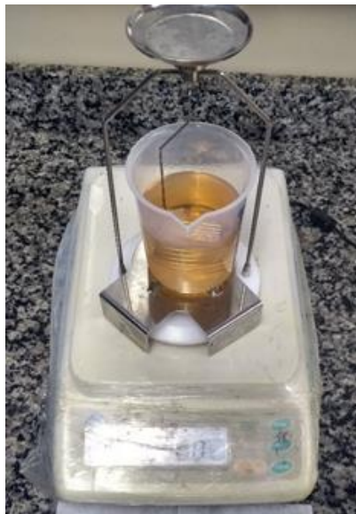
Figura 3.7 Balança hidrostática utilizada para a determinação da densidade pelo princípio de Arquimedes.
