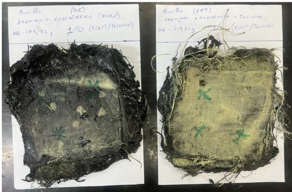
Figura 4.6 – Imagem do conjunto de amostras depois do ensaio balístico.
