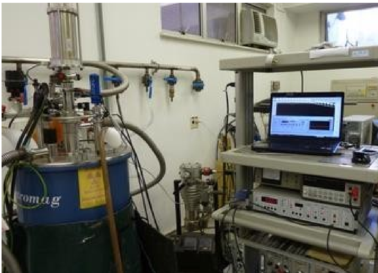
Figura 6 – Equipamento de Espectroscopia Mössbauer.
