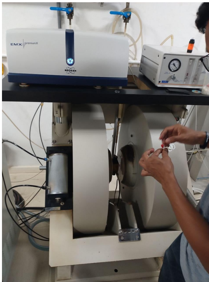
Figura 8 – Equipamento para medidas de EPR.
