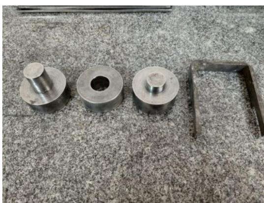
**Figura 3.3** – Matriz utilizada para a prensagem das amostras.
