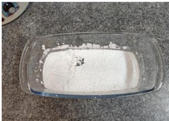
**Figura 3.2** – Mistura dos pós cerâmicos retirados da estufa já secos.
