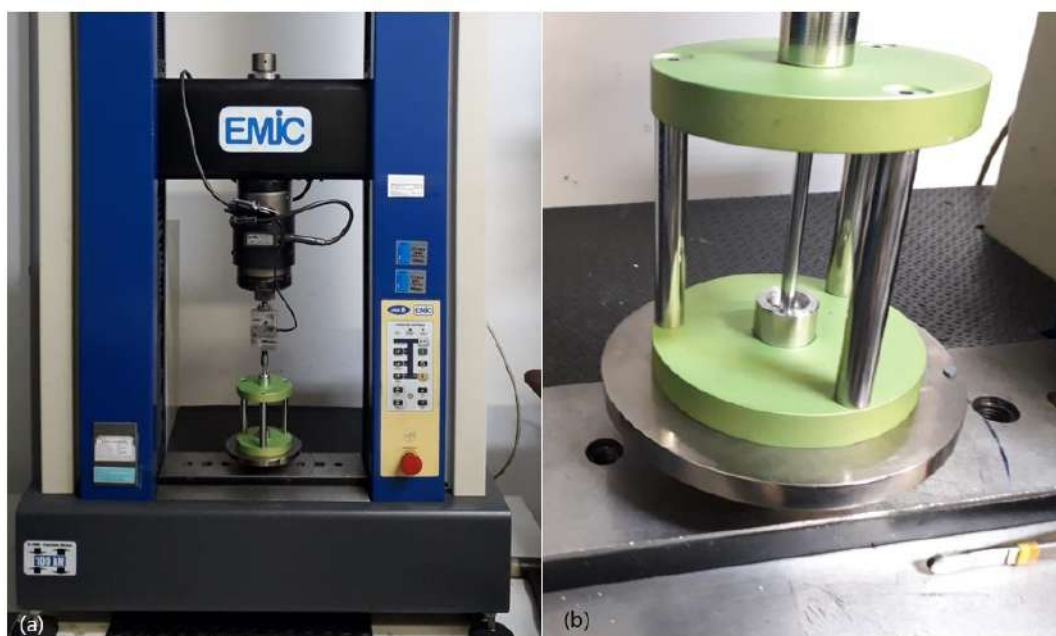
Figura 29 – Ensaio de Flexão Biaxial:(a) Equipamento Universal; (b) Dispositivo para Ensaio de Flexão.
