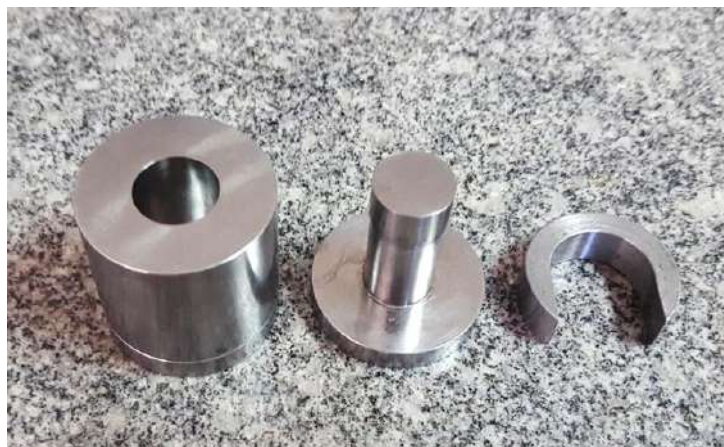
Figura 23 – Matriz de Compactação: (a) Matriz, (b) Punção, (c) Espaçador.
