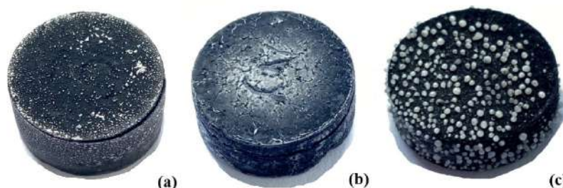
Figura 36 – Corpos de Prova Após a Retirada dos Ligantes - (a) S1; (b) S2; (c) S3.
