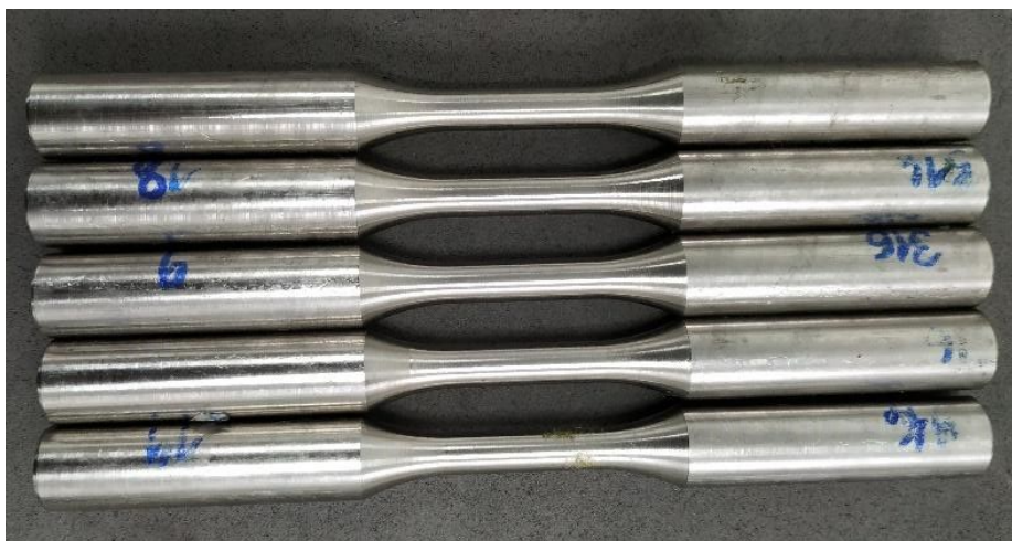
Figura 39 – Corpos de provas utilizados neste trabalho para os ensaios de tração e cíclicos.
