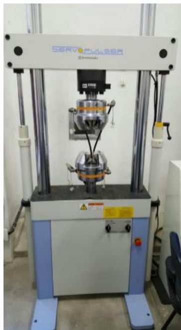
Figura 40 – Máquina de ensaio servohidráulica Shimadzu utilizado no presente estudo.
