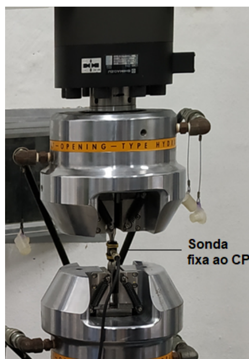
Figura 43 – Esquema de fixação do ferritoscopia na superfície do corpo de prova de ensaio cíclico.
