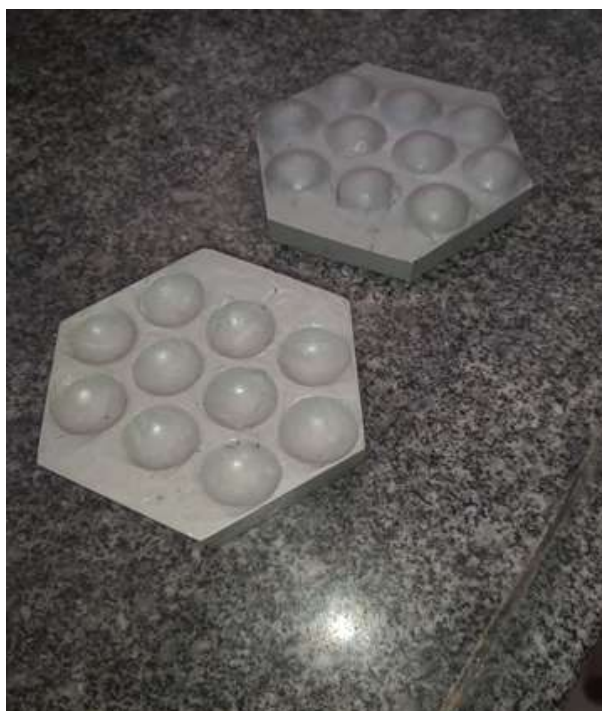
Figura 3.3 – Matriz de durepoxi com esferas de vidro.
