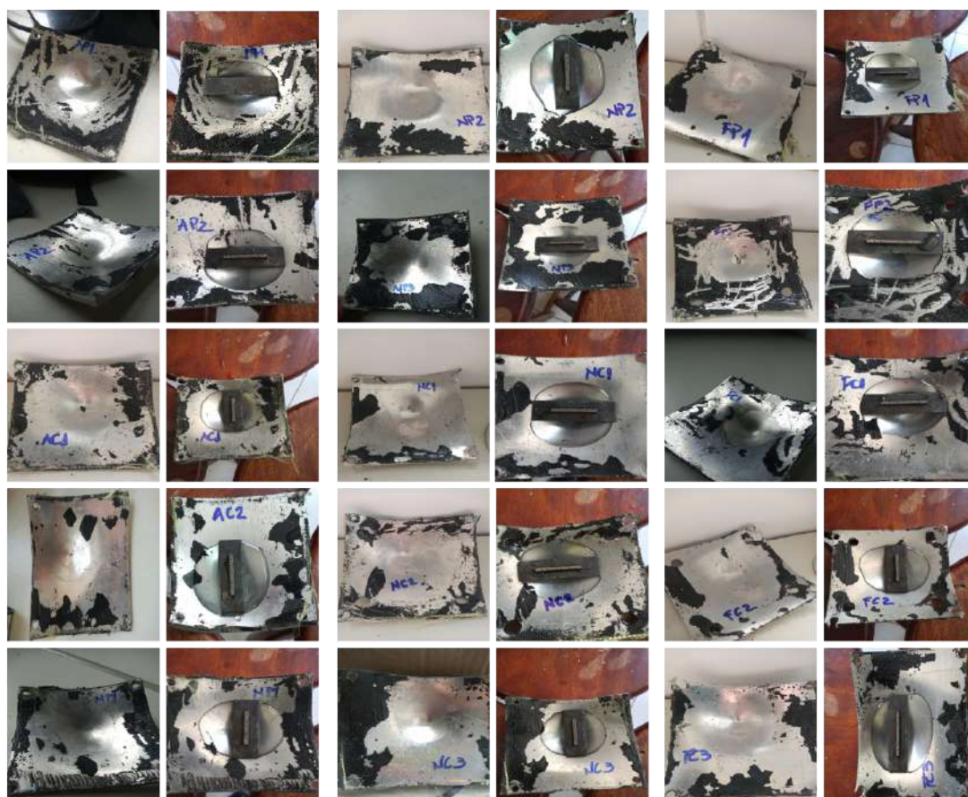
Figura 4.11 – Corpos de prova após o ensaio balístico.
