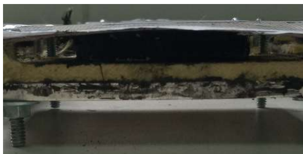
Figura 3.7 – Vista lateral da placa balística, como o selante espalhado nas laterais da chapa cerâmica.
