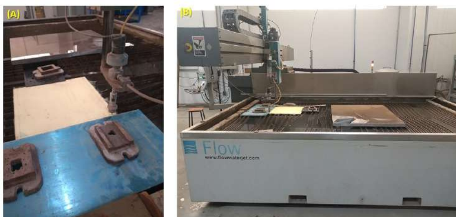
Figura 3.6 – (A) Tecido de aramida 50 x 50 cm; (B) Máquina de corte a jato d’água.
