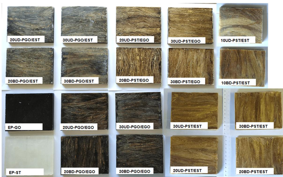
Figura 3.7 – Algumas placas compósitas produzidas nas diferentes frações de fibra, configurações (UD e BD), com e sem funcionalização de GO, além da placa de resina epóxi (Autor).
