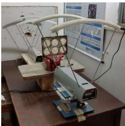
Figura 3.11 – Sistema de detecção no ensaio de energia de absorção (Autor).
