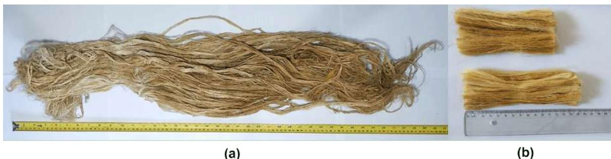
Figura 3.1 – Fibras de PALF (a) conforme adquirido e (b) após procedimentos de preparo (Autor).
