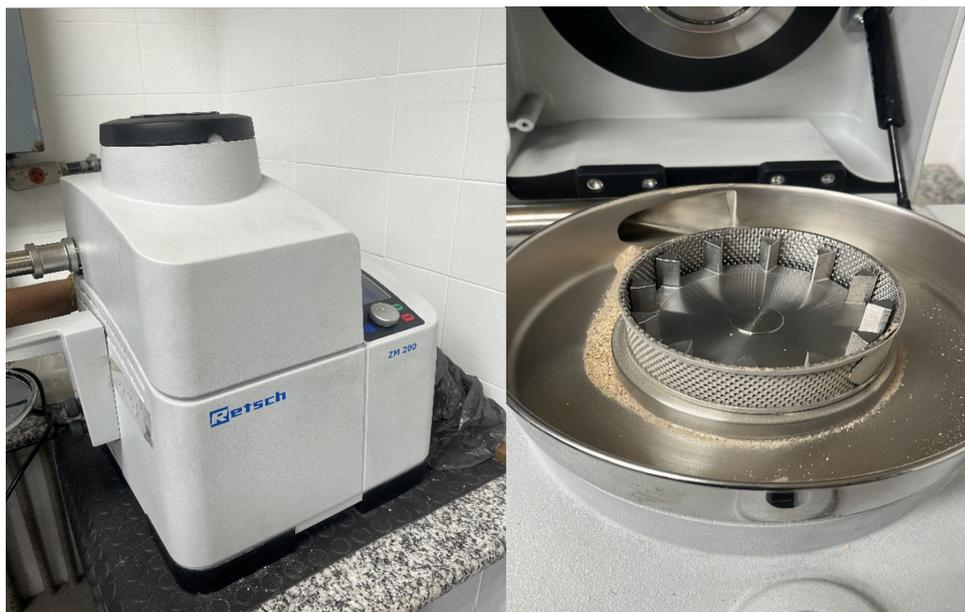
Figura 13 – Imagens da vista externa e interna do Moinho Ultracentrífugo RETSCH ZM 200
