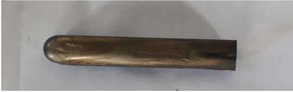
FIG. 3.5 – Lingote com comprimento inicial de 85,92 mm, antes do forjamento rotativo.
