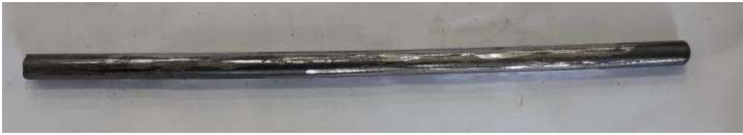
FIG. 3.8 – Barra com comprimento final de 196,00 mm e diâmetro de 7,73 mm, após 5 passes de forjamento rotativo a quente.
