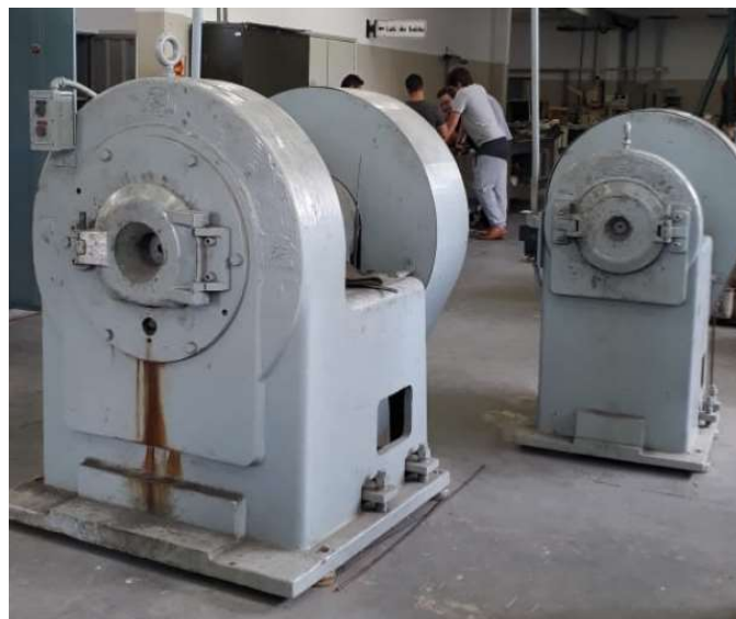
FIG. 3.7 – Forjadoras rotativas com 4 martelos e 2 martelos nas instalações do ITA, Campinas/SP, Brasil.
