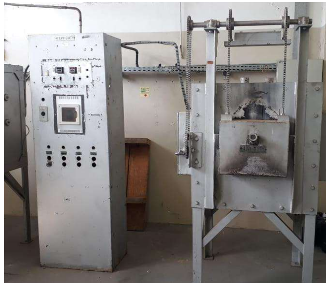
FIG. 3.6 – Forno mufla com sistema de controle de temperatura acoplado, utilizado nas etapas de reaquecimento do lingote e barra entre passes de redução no forjamento rotativo a quente.
