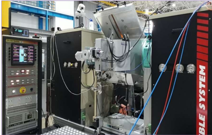
FIG. 3.1 – Gleeble® System associado a um difratômetro (XRD-1/XTMS).
