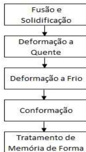
FIG. 2.10 – Fluxograma do processo de fabricação das ligas de NiTi (Adaptado de OTSUKA, WAYMAN, 1998).
