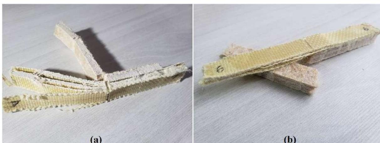
Figura 4.22 – CP do compósito (a) 10T2C e (b) 5T3C, após o ensaio de impacto Charpy.
