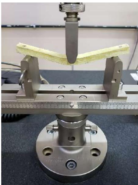
Figura 3.16 – Ensaio de flexão de corpo de prova do compósito 19T0C na INSTRON 5969.
