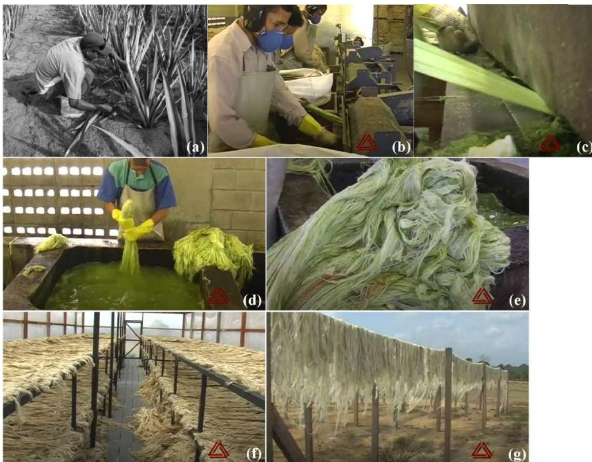
Figura 2.43 – Processo de produção de fibras de curauá: (a) corte das folhas, (b) e (c) decorticação das folhas em equipamento adaptado com proteção para as mãos, (d) lavagem das fibras após mercerização, (e) fibras lavadas e secagem das fibras (f) em estufa e (g) ao sol.
