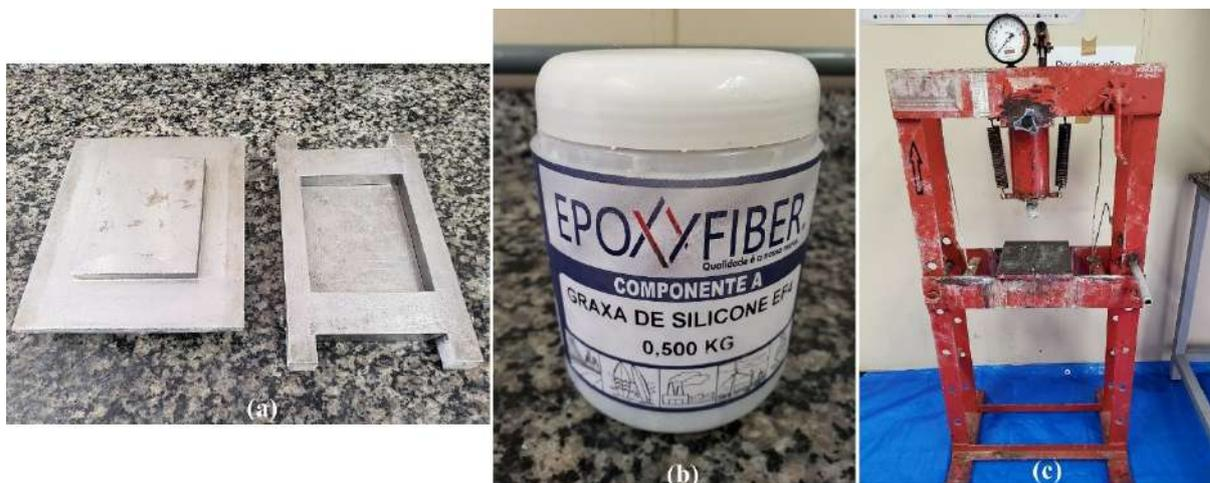
Figura 3.5 – (a) molde metálico, (b) desmoldante e (c) prensa hidráulica utilizados.
