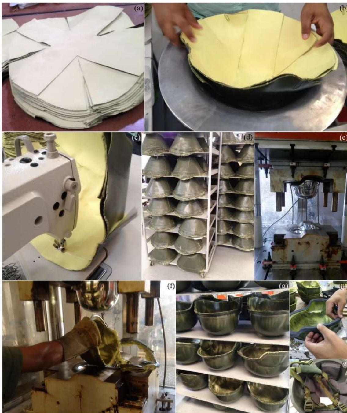
Figura 2.109 – Etapas do processo de fabricação de capacetes balísticos.
