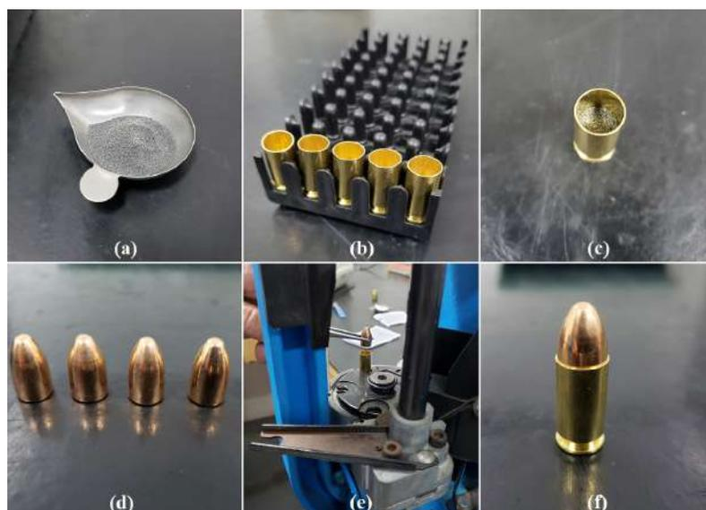
Figura 3.24 – Processo de preparação das munições 9x19mm utilizadas: (a) pólvora CBC base dupla PCL 504, (b) estojos 9x19mm, (c) estojo com quantidade de pólvora para nível II, (d) projétil FMJ 9mm, (e) engastamento do projétil no estojo e (f) munição 9x19mm pronta.
