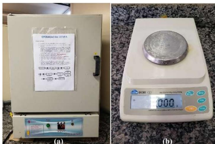
Figura 3.6 – (a) Estufa de secagem e (b) balança de precisão utilizadas.
