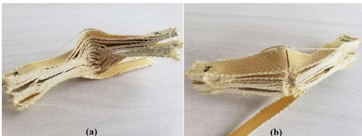
Figura 4.21 – CP do compósito 19T0C após o ensaio de impacto Charpy: (a) lado do impacto e (b) lado do entalhe.
