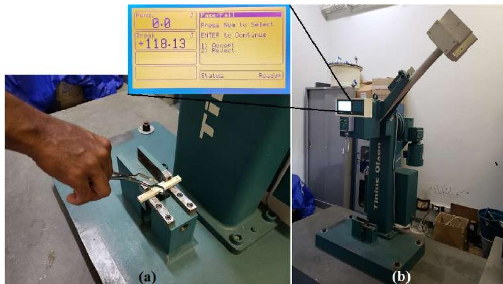
Figura 3.18 – Ensaio de impacto Charpy de CP do compósito 19T0C: (a) posicionamento do CP no pêndulo e (b) detalhe do mostrador digital do pêndulo após o ensaio.
