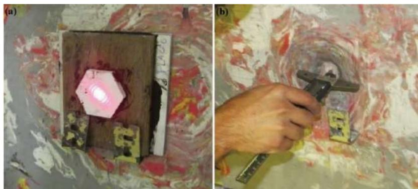
Figura 2.52 – (a) SBM com placa compósita de epóxi/bambu pronto para o teste balístico, e (b) aferição da deformação posterior projetada no anteparo de plastilina.
