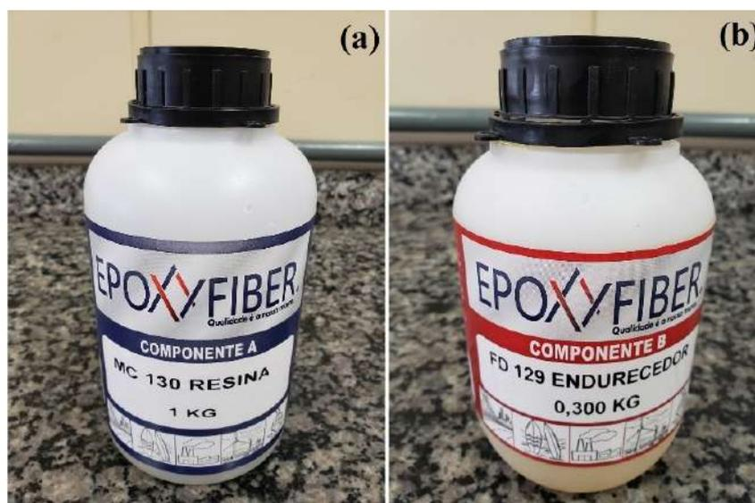
Figura 3.2 – Sistema epoxídico utilizado: (a) resina epóxi MC 130 e (b) endurecedor FD 129.
