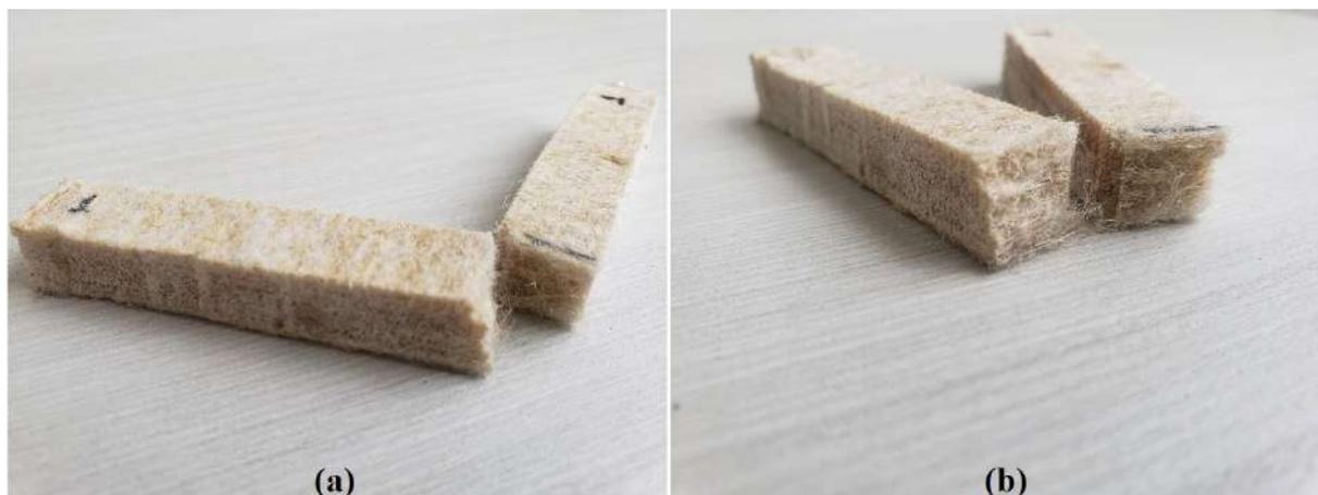
Figura 4.23 – (a) e (b) CP do compósito 0T4C após o ensaio de impacto Charpy.
