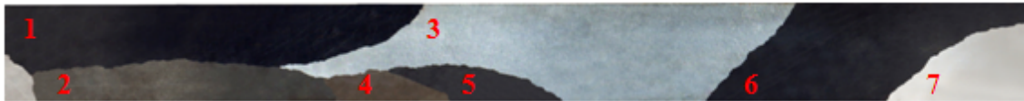
FIG. 4.33 Amostra com 13,2% de estiramento com identificação numérica dos grãos para análise de textura secundária.
