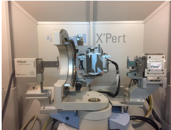
FIG. 3.11 Amostra inserida no DRX X'PERT PRO MRD, PANalytical do IME para análise da orientação dos grãos em estrutura secundária do aço Si GO.
