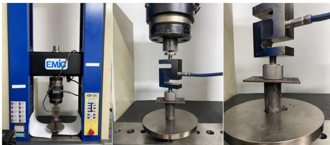
Figura 13 – Equipamento de ensaio à compressão (Arquivo Pessoal)
