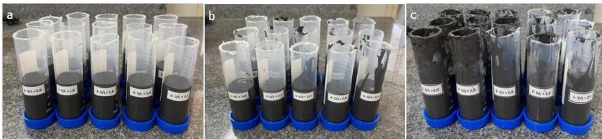
Figura 15 – Amostras nos moldes cilíndricos: (a) 1.6; (b) 1.8; (c) 2.0. (Arquivo Pessoal)
