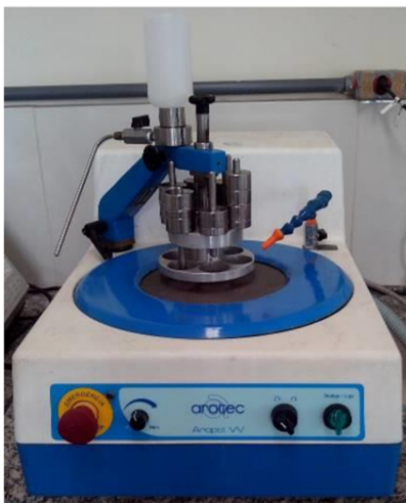
Figura 3.5 – Polimento das amostras em politriz Arotec VV com aparato automatizado de polimento
