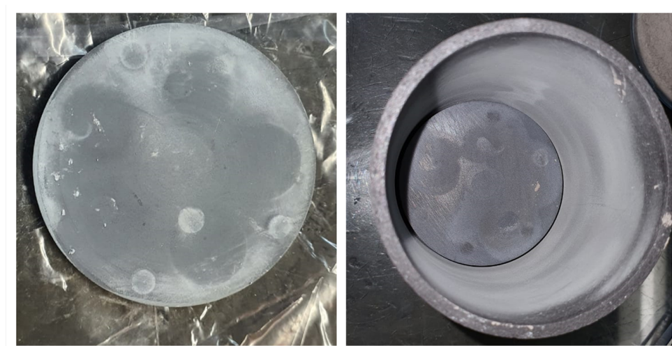
Figura 4.17 – Contaminação das paredes do forno
