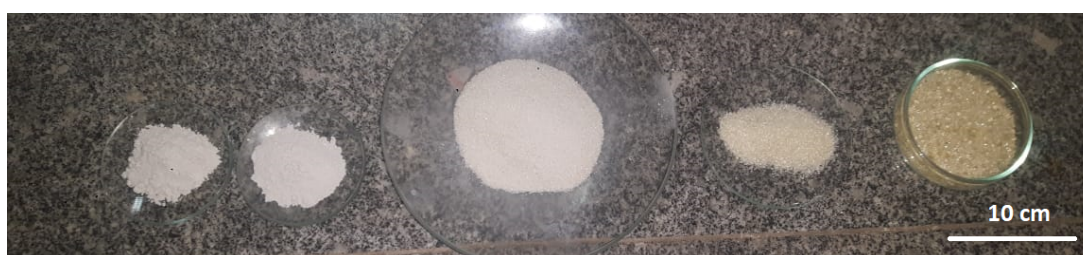
Figura 3.2 – Granulometria heterogênea do LAS como recebido
