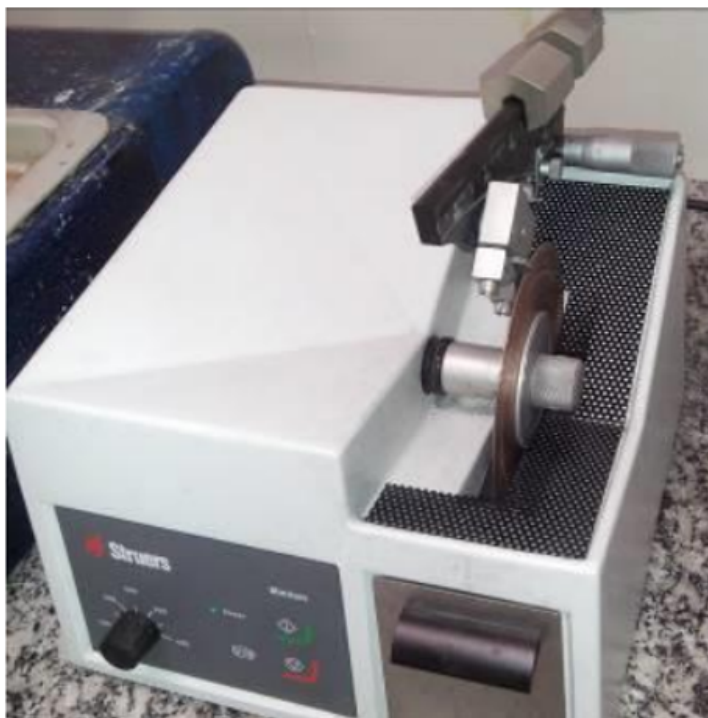
Figura 3.8 – Corte da amostra M0 em cortadora de precisão Struers Minitom
