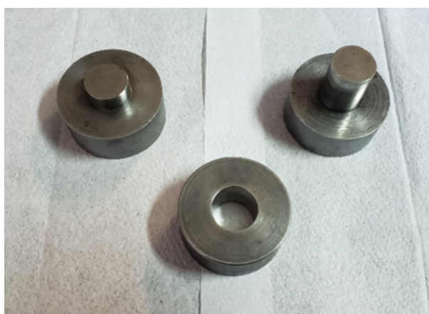
Figura 3.3 – Matriz cilíndrica de 20mm de diâmetro e punções
