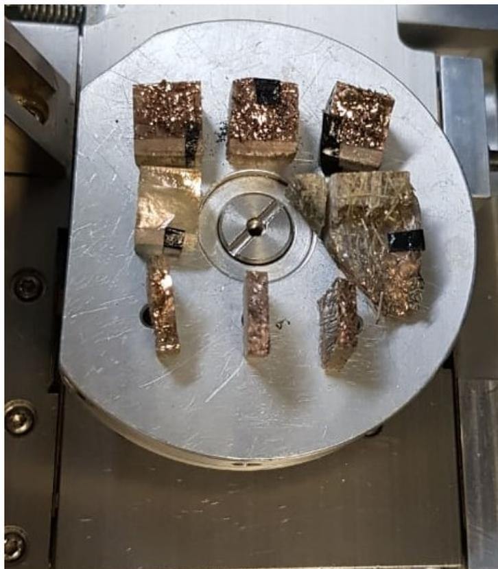
Figura 3.18 – Amostras dos compósitos após o recobrimento de ouro realizado.
