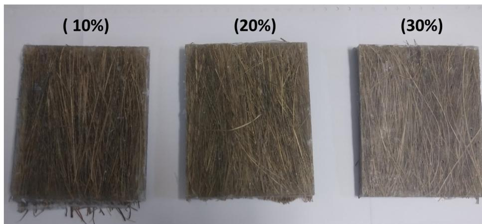
Figura 3.9 – Placas de compósitos com percentuais de fibras correspondentes a 10, 20 e 30% em volume.
