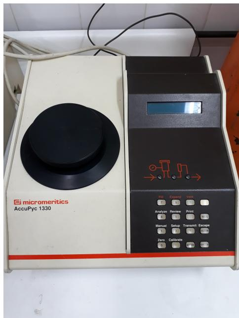
Figura 3.16 – Picnômetro de Hélio da marca Micromeritics pertencente ao IPQM.
