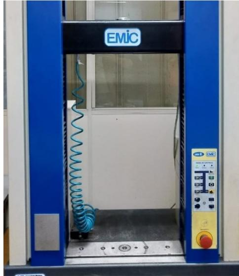
Figura 3.5 – Máquina de ensaio de tração modelo EMIC.
