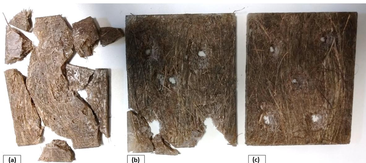
Figura 4.41 – Aspecto macroscópico dos compósitos após o impacto balístico, nas condições de: (a) 10% v/v, (b) 20% v/v e (c) 30% v/v.
