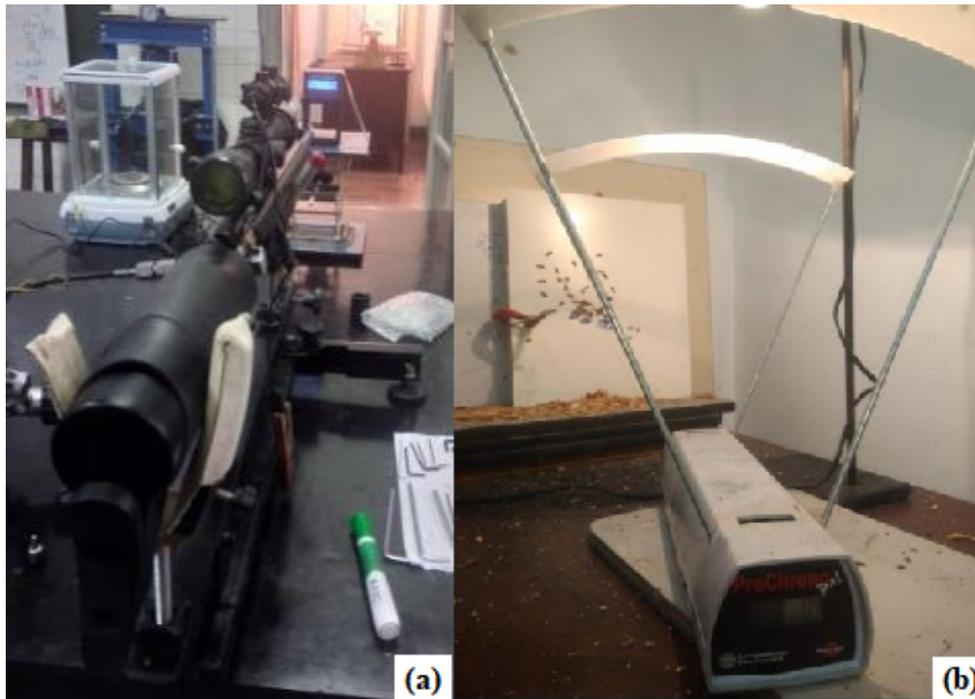
Figura 3.19 – Equipamentos utilizados no ensaio balístico (a) rifle de ar; (b) cronógrafo. (LUZ et al., 2019) (adaptado).
