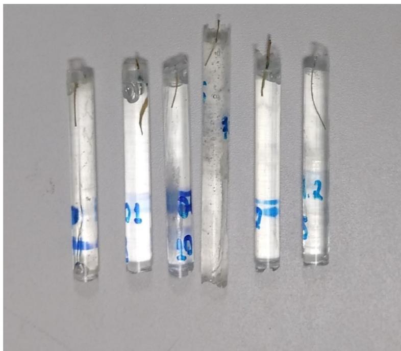
Figura 3.7 – Algumas corpos de prova de fibras de junco-sete-ilhas embutidas em uma matriz epóxi.
