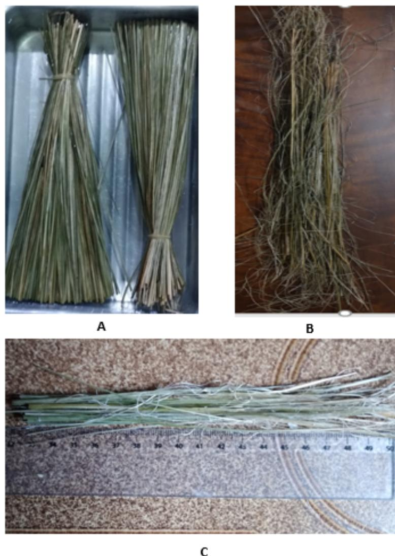
Figura 3.3 – (a) junco-sete-ilhas imerso em água durante um período de 24 horas; (b) fibras desfiadas; (c) corte das fibras de junco em 150 mm.
