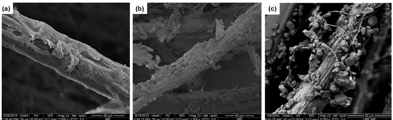
Figura 4.26 - Micrografia da fibra de Buriti (a) antes do ensaio balístico, com um aumento de 2500x e (b) após o ensaio balístico, com um aumento de 1300x e (c) fibra de Kevlar™ após ensaio balístico (Adaptado) (BRAGA et al, 2017).
