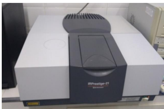
Figura 3.17 - Espectrômetro de infravermelho com transformada de Fourier (FTIR) em um modelo IR PRESTIGE 21-FTIR-SHIMADZU.
