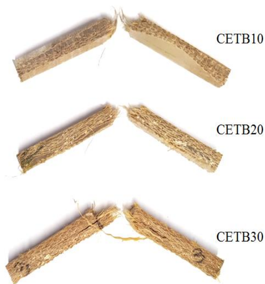
Figura 4.18 - Característica macro das fraturas das amostras ensaiadas no Impacto Charpy para os compósitos epoxídicos reforçados com tecido de buriti em 10, 20 e 30%.
