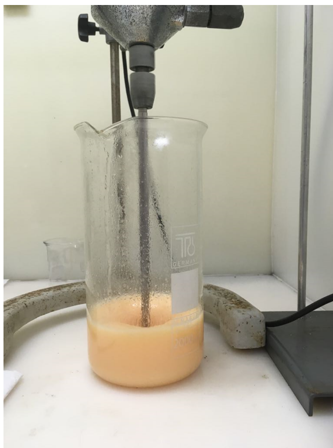
FIG. 3.3: Sistema reacional para epoxidação de óleo vegetal.
