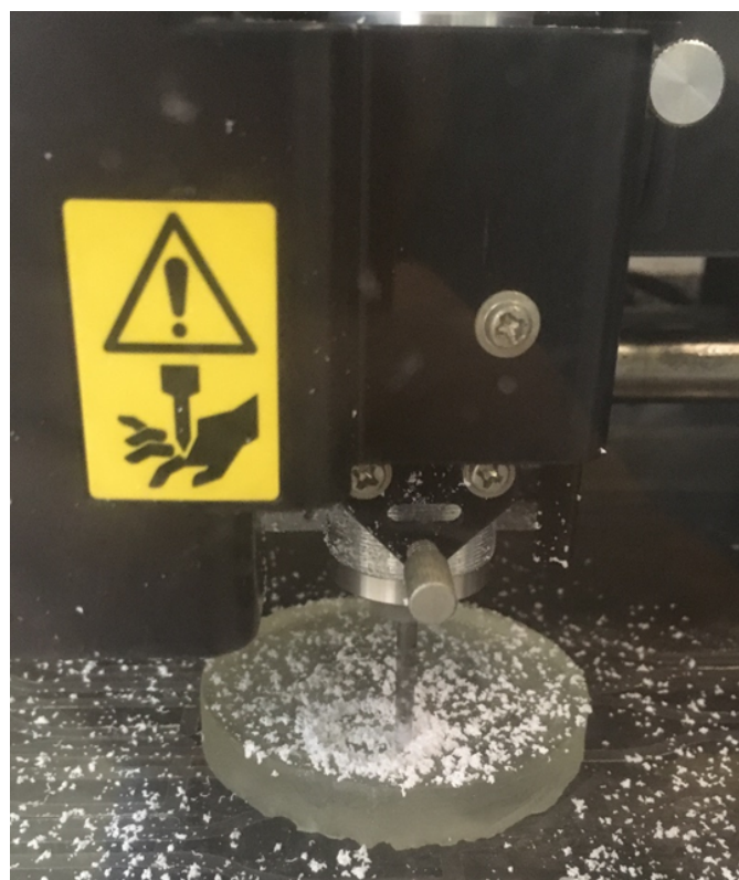
FIG. 3.9: Usinagem dos corpos de prova.
