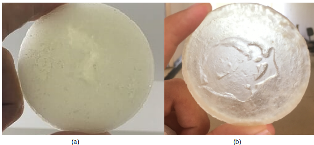
FIG. 4.11: Peças cilíndricas poliméricas: (a) Material não degasado; (b) Material degasado.
