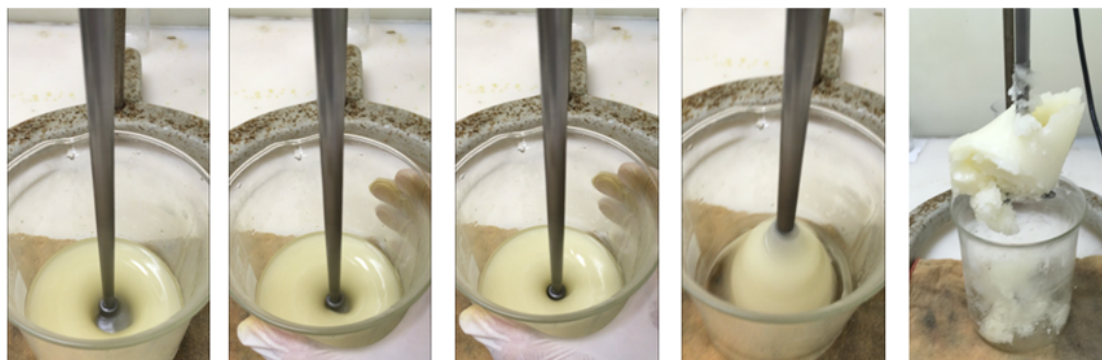
FIG. 3.6: Polimerização de óleo vegetal epoxidado.
