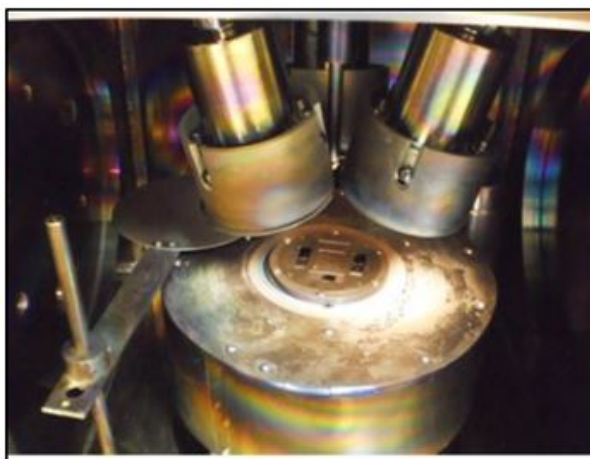
Figura 3.2 – Parte interna da câmara de deposição contendo o alvo de Mo, os substratos de vidro soda-lime na base giratória e o “shutter”.
