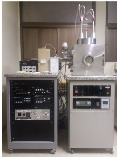
Figura 3.1 – Equipamento de pulverização catódica com RF e magnetron.
