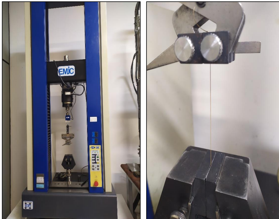
Figura 3.5 – Ensaio de tração nas fibras de coco.
