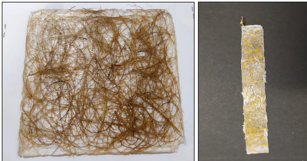
Figura 3.3 – Placa do compósito e corpo de prova para o ensaio de tração.
