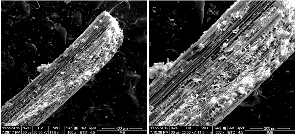
Figura 4.27 - Ponta da fibra 100 UV após o ensaio de Pullout.
