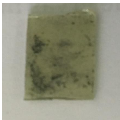
FIG. 4.45 Fotografia do filme de perovskita que sofreu o processo de degradação reversível.
