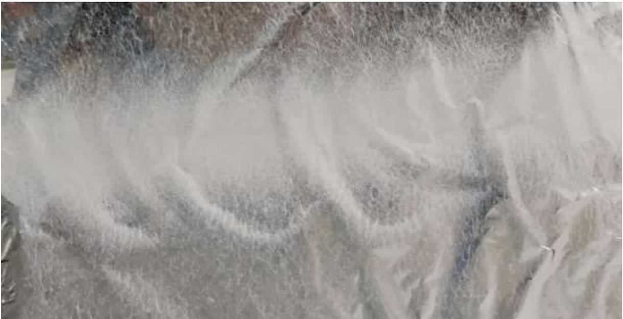
Figura 4.1 – Fibras depositadas em folha de alumínio em 16%w/v a 60psi
