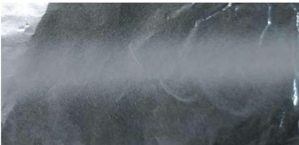
Figura 4.3 – Fibras depositadas em folha de alumínio em 18%w/v a 60psi
