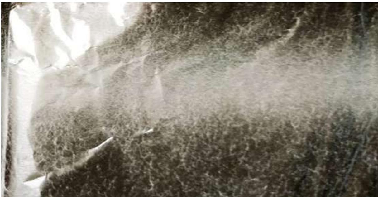
Figura 4.2 – Fibras depositadas em folha de alumínio em 17%w/v a 60psi
