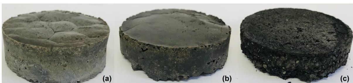
FIGURA 3.7: Corpos de prova 80/20 (a), 60/40 (b) e 40/60 (c) para o ensaio balístico.
