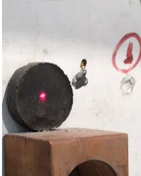
FIGURA 3.9:Posicionamento da amostra no ensaio balístico.
