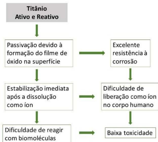
Figura 10 – Excelente resistência à corrosão e baixa toxicidade do titânio baseada em sua alta atividade. Adaptada de (2).
