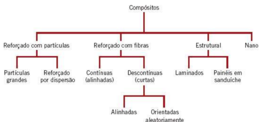
Figura 2.11 – Classificação dos materiais compósitos
