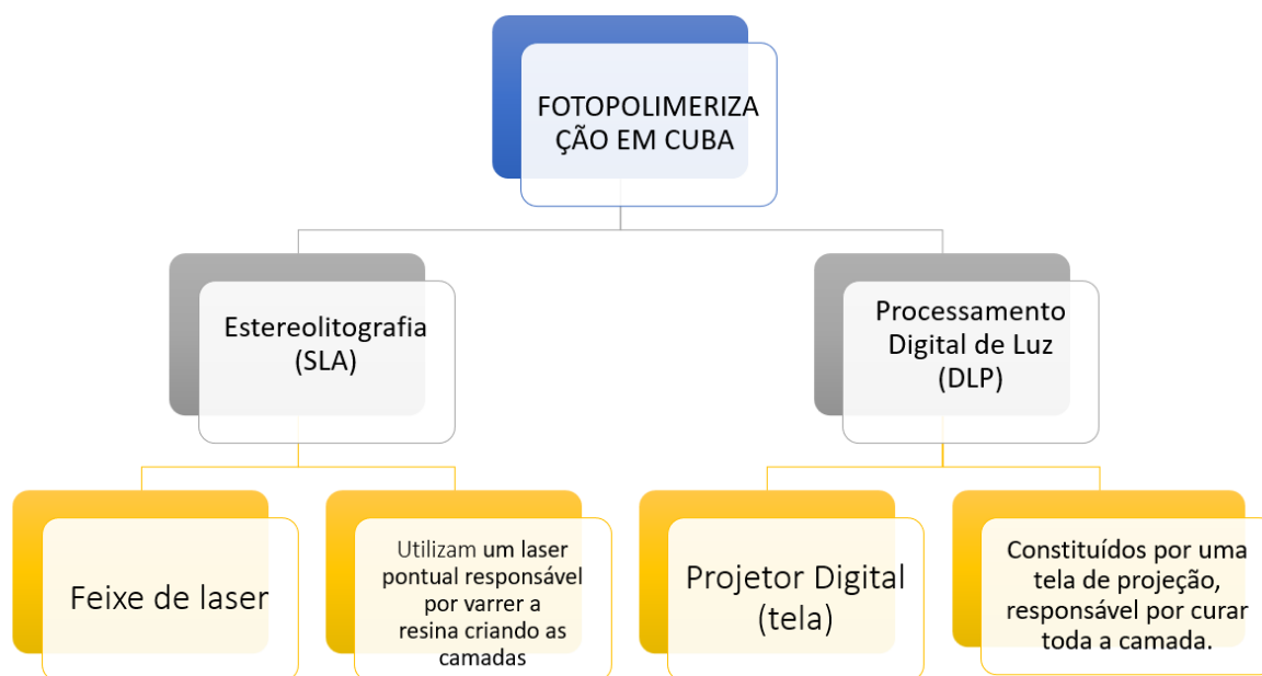
Figura 8 – Principais processos de MA por Fotopolimerização em cuba.
