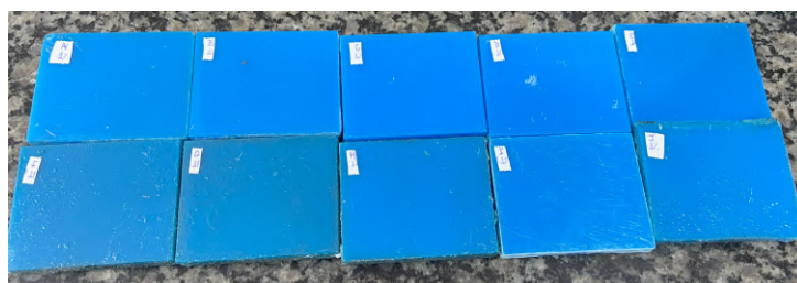
Figura 39 – Amostra para ensaio de velocidade residual produzidas por MA.
