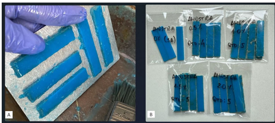
Figura 37 – (A) Amostras para DMA recém impressa. (B) Amostras dos compósitos para DMA.
