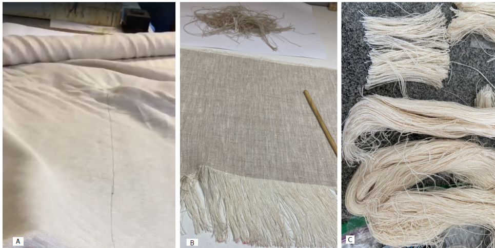
Figura 19 – (A) Tecido de linho como recebido, (C) em processo de desfiamento e linhas desfiadas.
