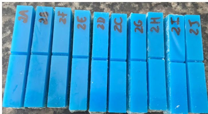
Figura 32 – Corpos de prova para ensaio de impacto compósito 2% de fibra de linho.
