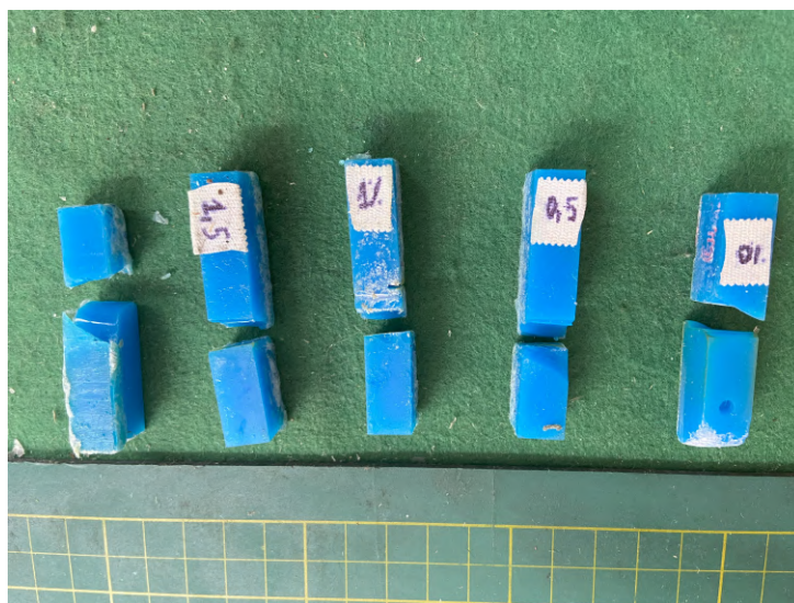
Figura 45 – Comparação das energias de fratura dos compósitos, obtidas nos ensaios de impacto Charpy
