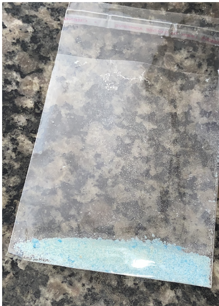
Figura 36 – Amostra do compósito 0,5% cominuída para TGA.
