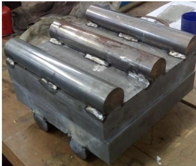
FIG. 3.8: Matrizes inferior e superior com os cilindros soldados.
