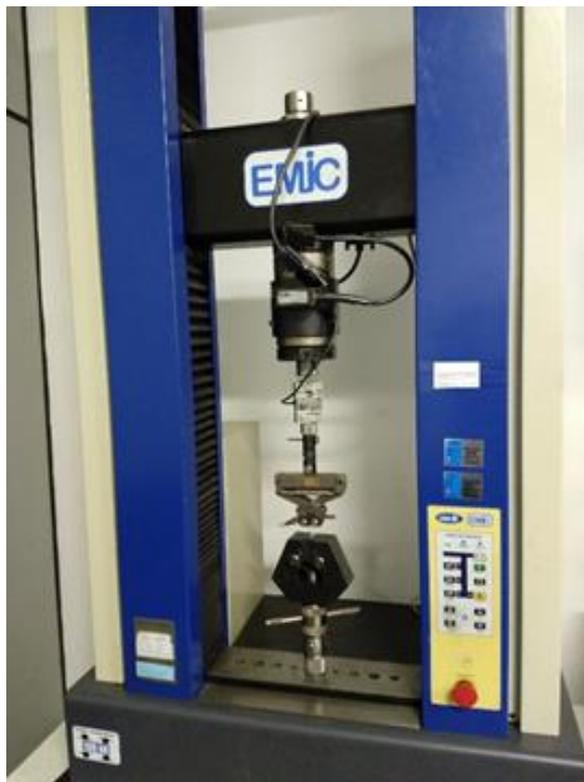
FIG. 3.21: Máquina universal de ensaio EMIC, DL 10000.
