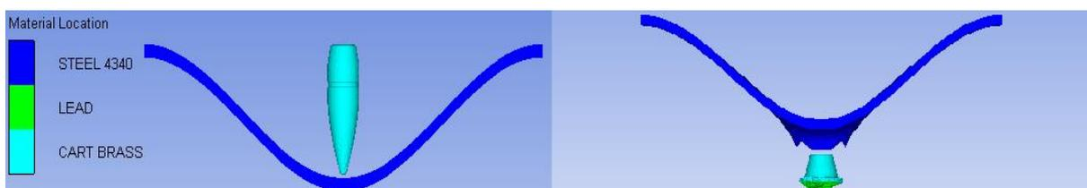
FIG. 4.4: Simulação em Placa Poliondular (Posição 3).
