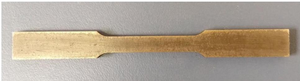
FIG. 3.22: Corpo de prova utilizado no ensaio de tração.
