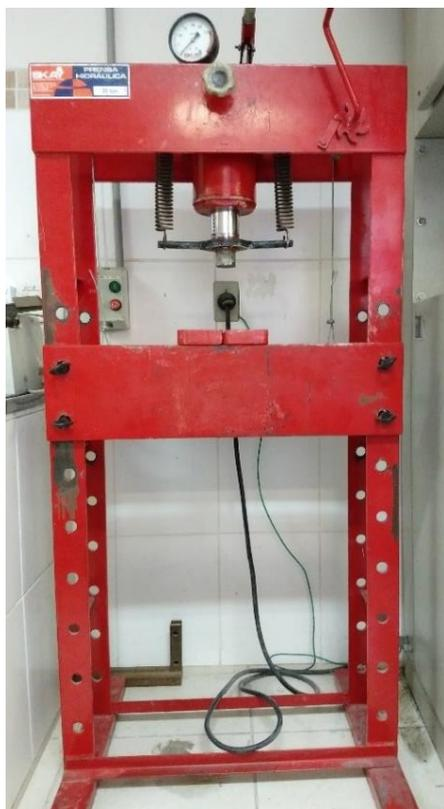
FIG. 3.15: Prensa Hidráulica SKAY P30
