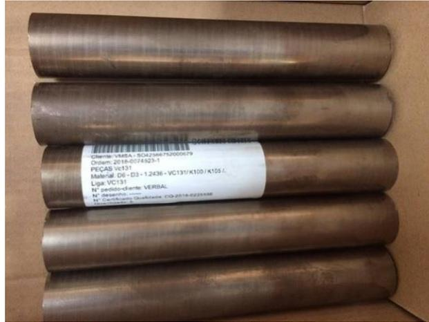
FIG. 3.7: Cilindros de aço ferramenta VP131 utilizados nas matrizes.
