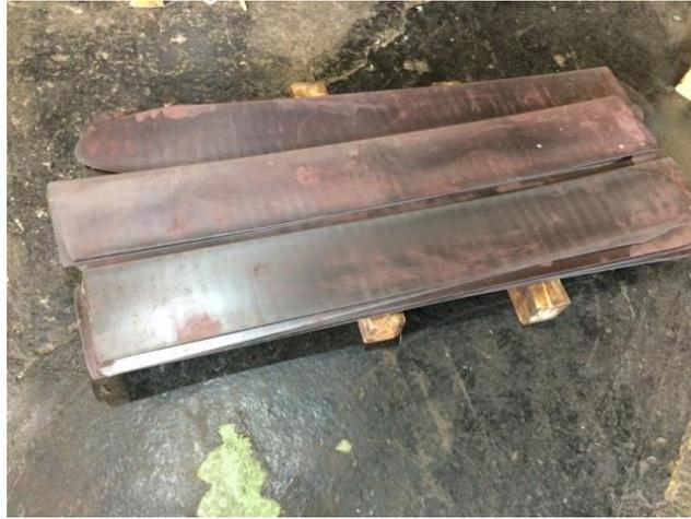
FIG. 3.4: Blocos de aço *maraging* 250 após laminação.
