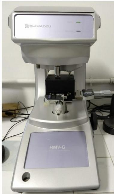
FIG. 3.18: Durômetro Shimadzu HMV-G21.
