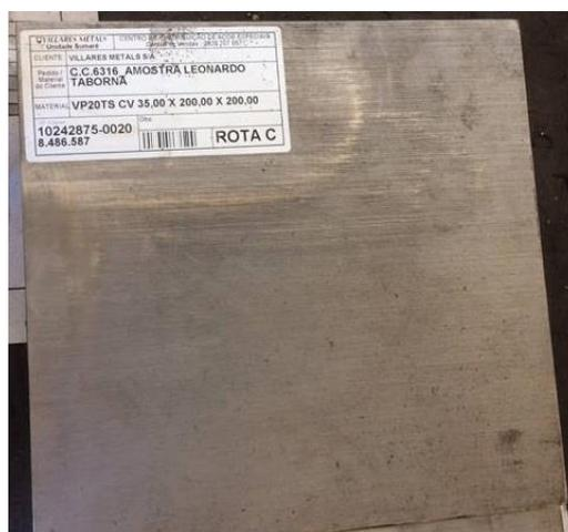
FIG. 3.6: Blocos de aço ferramenta VP20 das matrizes.
