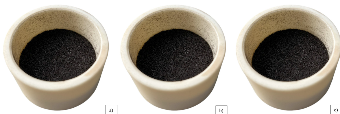
Figura 22 – Cadinho contendo cinzas obtidas após o processo de carbonização, a) 300°C por 40 minutos, b) 400°C por 60 minutos e c) 500°C por 120 minutos.
