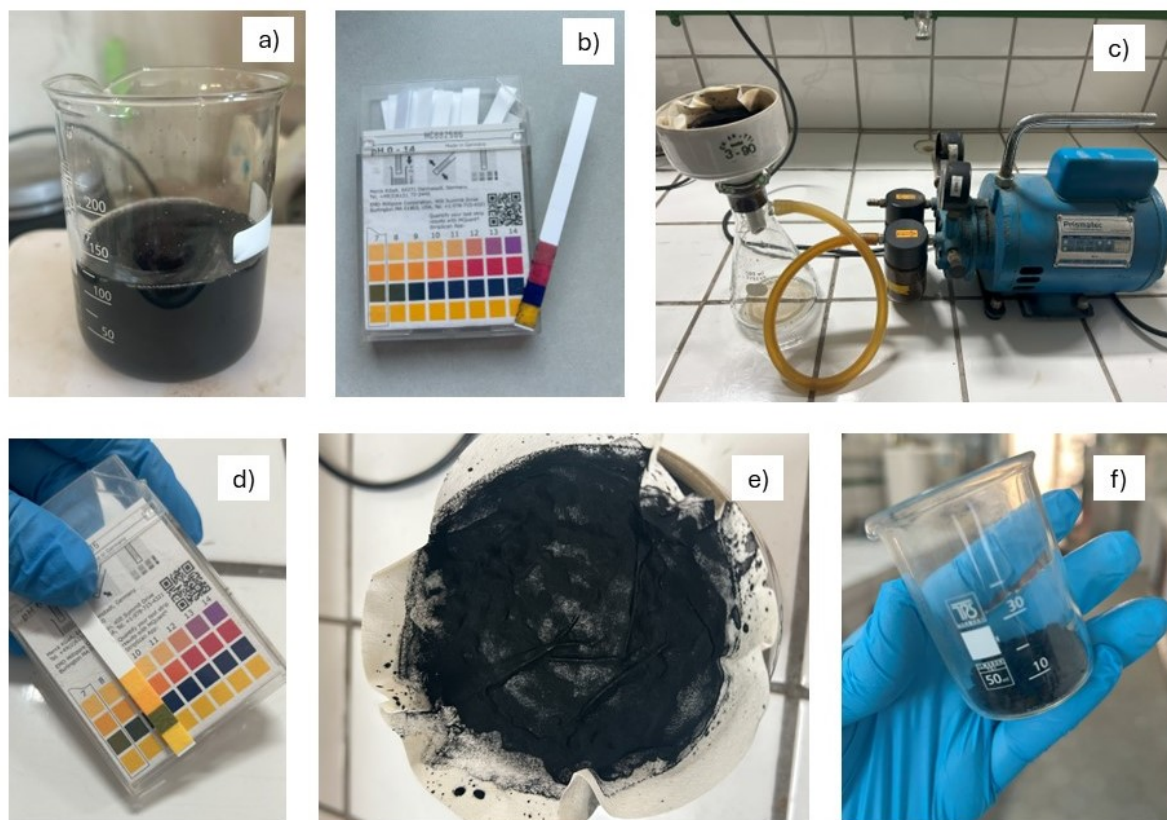
Figura 23 – Etapas do processo de agitação magnética e filtração das cinzas de serragem ativadas com KOH.
