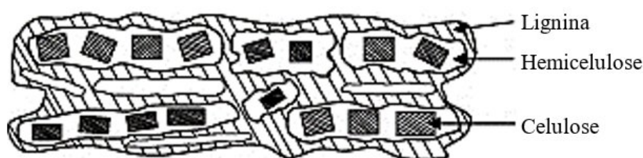
Figura 3 – Organização estrutural dos três principais constituintes da parede celular da madeira (Adaptado de (3)).
