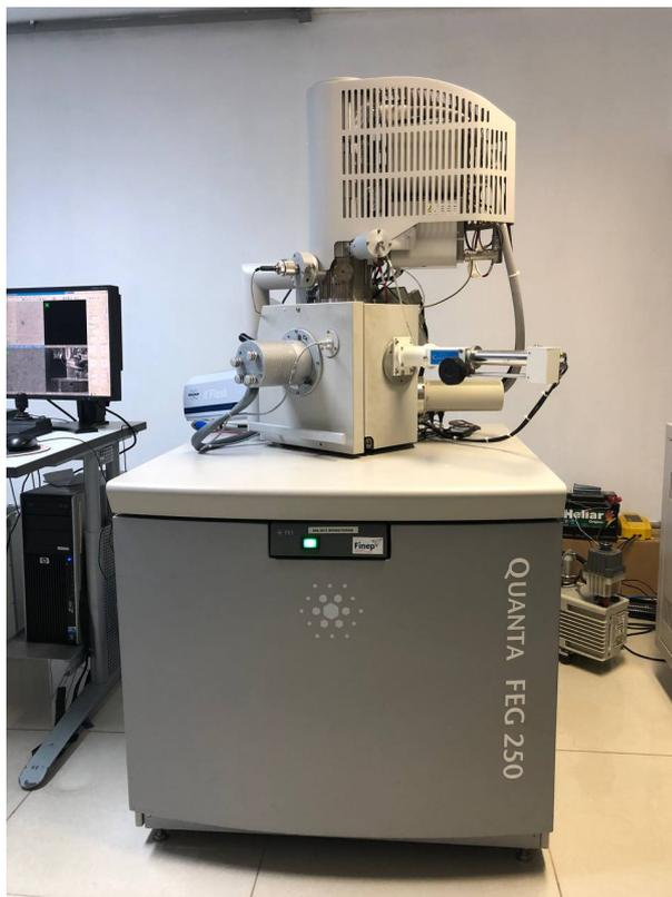
Figura 34 – Microscópio eletrônico de varredura da marca FEI, modelo QUANTA FEG 250.
