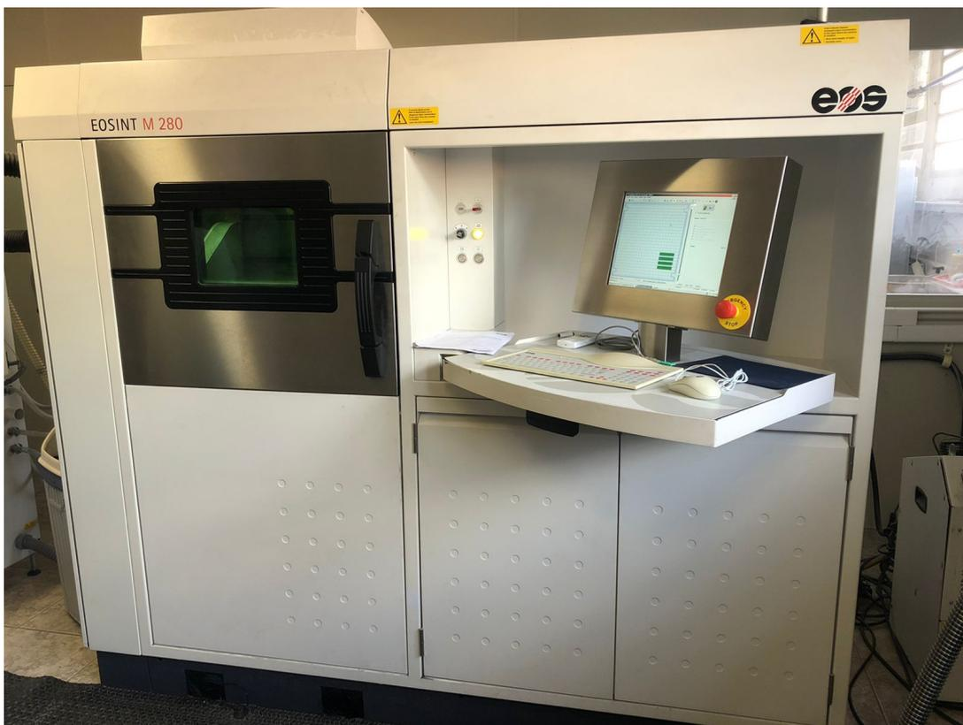
Figura 38 – Equipamento de manufatura aditiva EOSINT M280.
