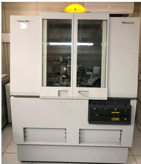
Figura 35 – Difratômetro X'PERT PRO MPD.
