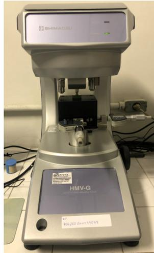
Figura 45 – Equipamento utilizado no ensaio de dureza Vickers.
