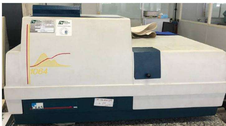
Figura 36 – Analisador de Partículas a Laser: *Particle Size Analyzer* Cilas 1064.
