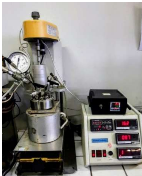
Figura 18 – Minirreator de bancada da marca Parr® utilizado no processo de coprecipitação.
