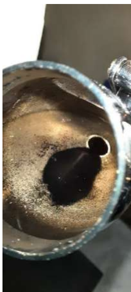
Figura 21 – Dispersão do T300 dentro do cilindro do equipamento de spray, mostrando decantação das partículas no fundo do armazenador de dispersão do aerógrafo, após 15 min.
