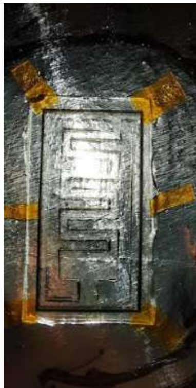
Figura 14 – Máscara de vinil fixada sobre o substrato de vidro, ambos presos em uma placa quente.
