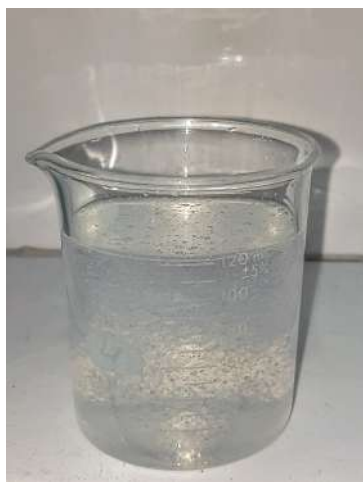
Figura 22 – Eletrólito em gel a base de PVA/ H_2SO_4 .
