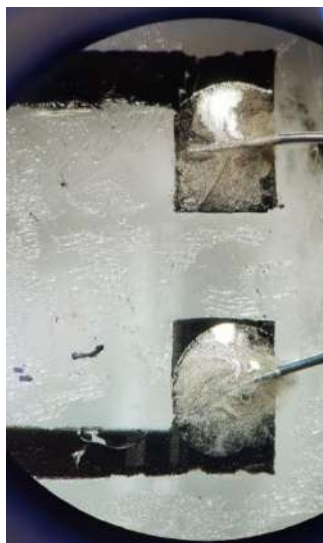
Figura 16 – Microscopia óptica dos contatos elétricos realizados no SC com tinta condutora de prata.
