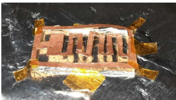
Figura 13 – Máscara de cobre fixada sobre o substrato de vidro, ambos presos em uma placa quente.
