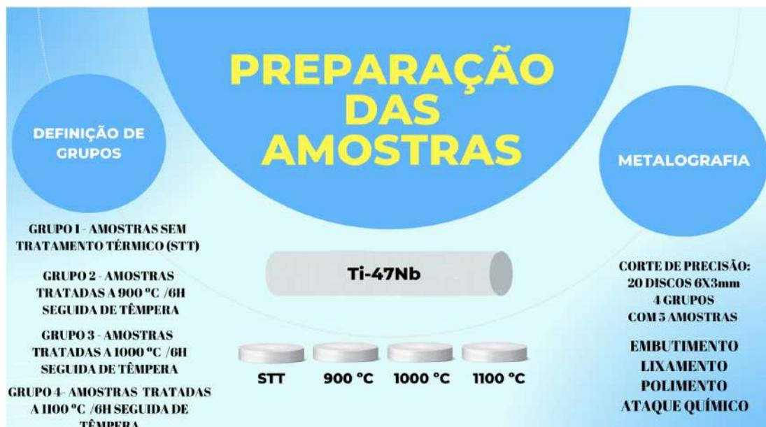
Figura 4 – Diagrama esquemático dos tratamentos térmicos e posteriores preparações adotadas nas amostras geradas no estudo.
