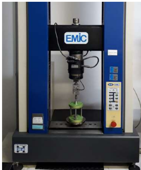
Figura 15 – Máquina Universal de Ensaio com o dispositivo de ensaio de flexão biaxial B3B.
