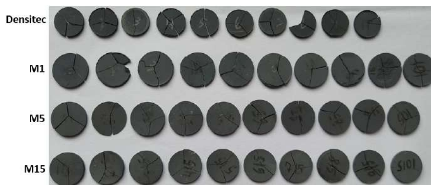
Figura 50 – Amostras fraturadas no ensaio B3B
