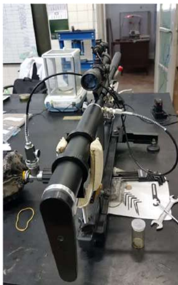
Figura 16 – Sistema utilizado para os ensaios balísticos
