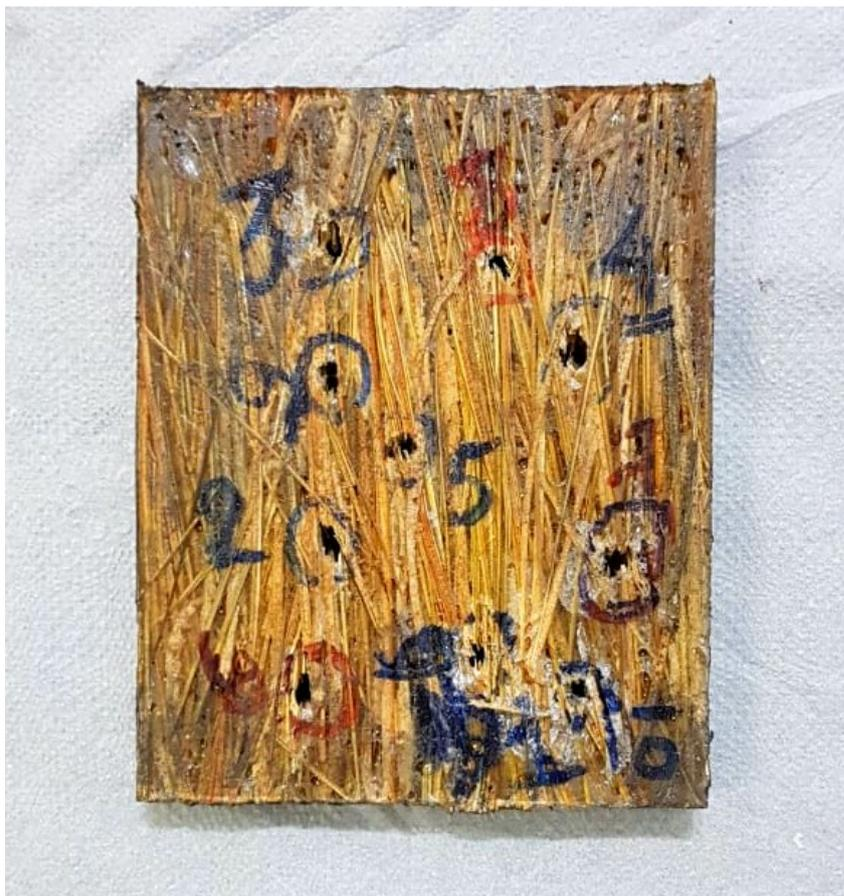
Figura 4.27 – Amostra após o ensaio de velocidade residual.
