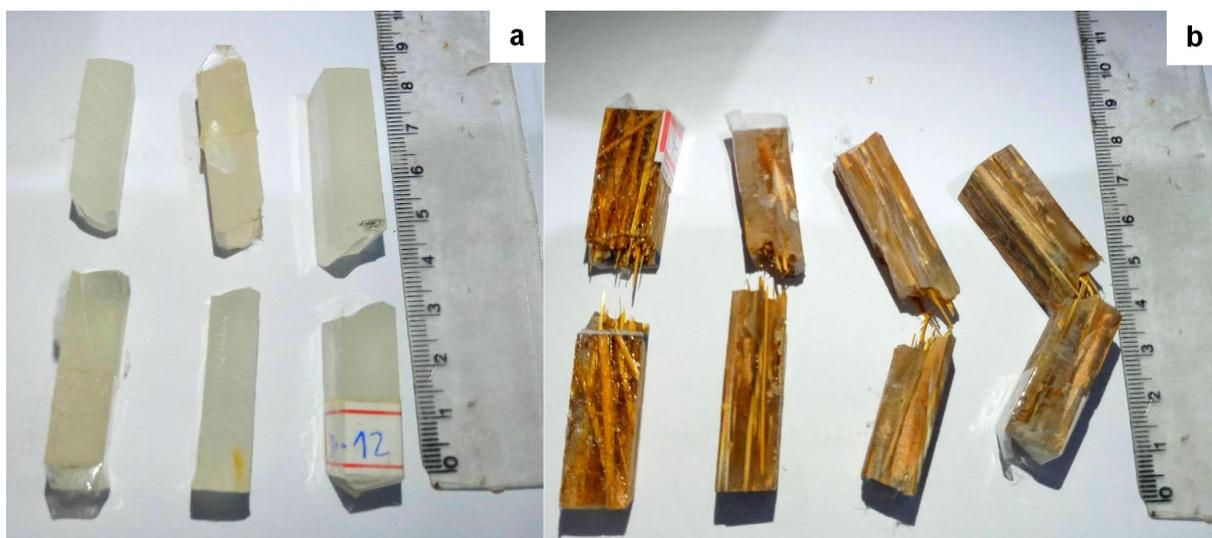
Figura 4.20 – Corpos de prova fraturados após ensaio de impacto izod. (a) 0% (b) 10%.
