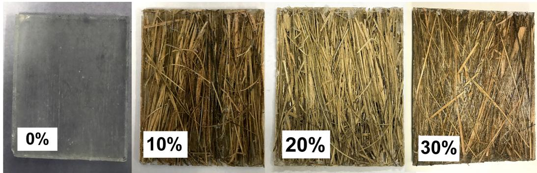
Figura 3.5 – Placa de resina epóxi e seus compósitos com diferentes percentuais de fibra caranã v/v.
