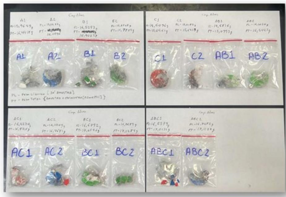
Figura 4.10 – Fragmentos dos corpos de prova após os disparos.
