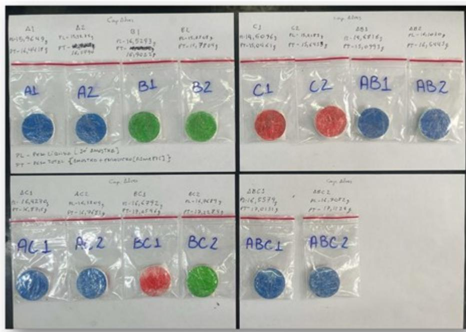
Figura 4.9 – Amostras preparadas para o ensaio balístico.
