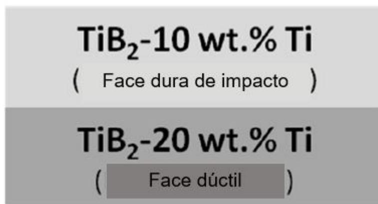
Figura 2.9 – Esquema do MGF utilizado no estudo.
