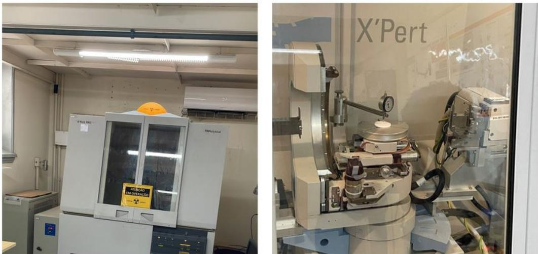
Figura 3.8 – Equipamento de DRX do laboratório do IME.
