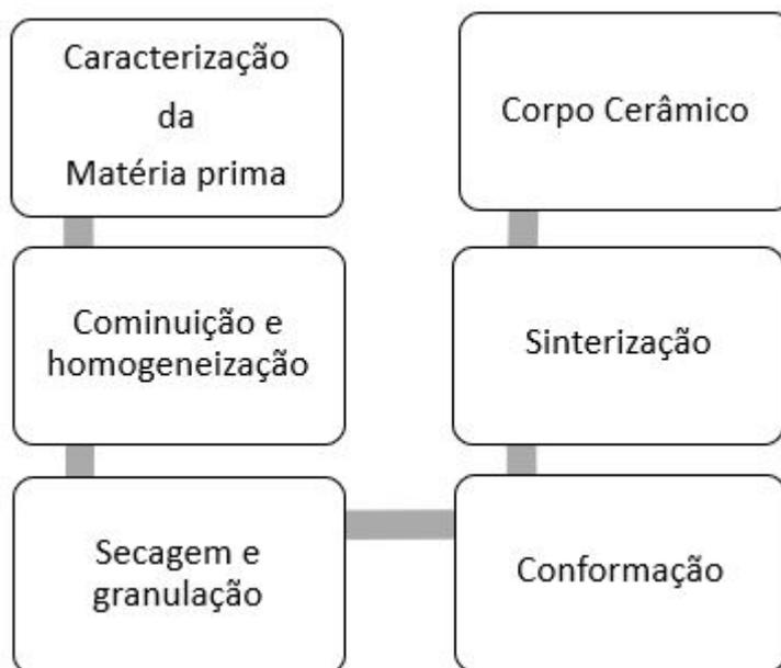
Figura 2.13 – Principais etapas do processamento cerâmico.
