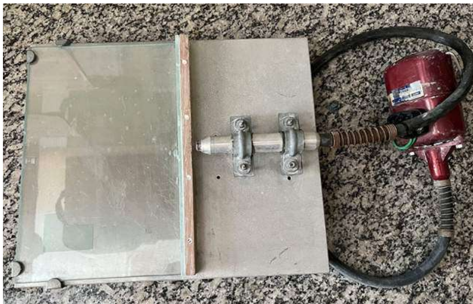
Figura 13 – Dispositivo utilizado para corte das amostras a partir dos blocos de zircônia pré-sinterizados.
