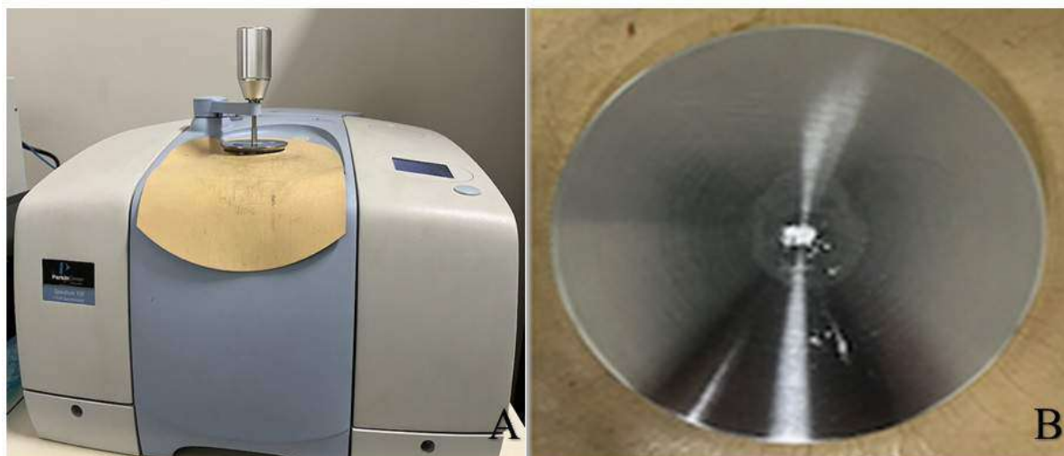
Figura 17 – (A) Espectrômetro Perkim Elmer (Spectrum 100) com acessório de refletância total atenuada, e (B) amostra posicionada para análise sobre o cristal de diamante.
