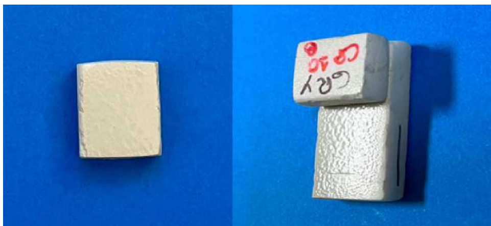
Figura 44 – Aspecto final das amostras pintadas (ambas da cor B).
