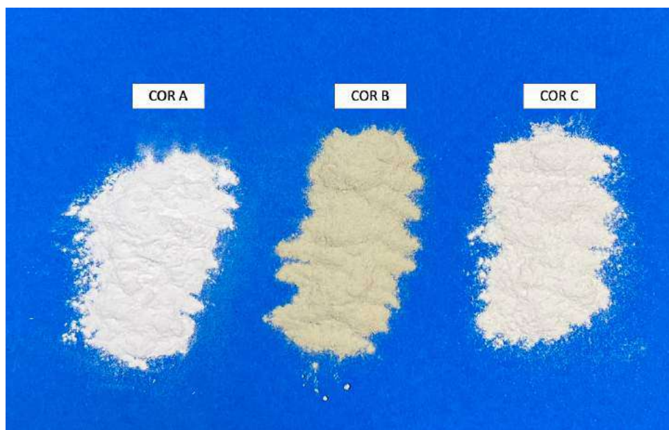
Figura 16 – As três cores de tinta em pó utilizadas: cor A – epóxi; cor B – poliéster/epóxi (híbrida); cor C – mistura de A e B (híbrida).
