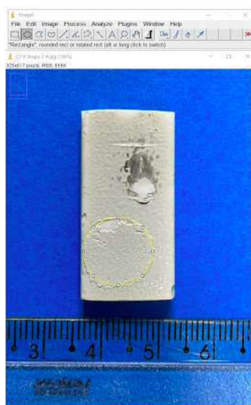
Figura 25 – Amostra maior do corpo de prova 6 (grupo Y) após separação no ensaio de resistência ao cisalhamento para análise da área de contato no ImageJ.
