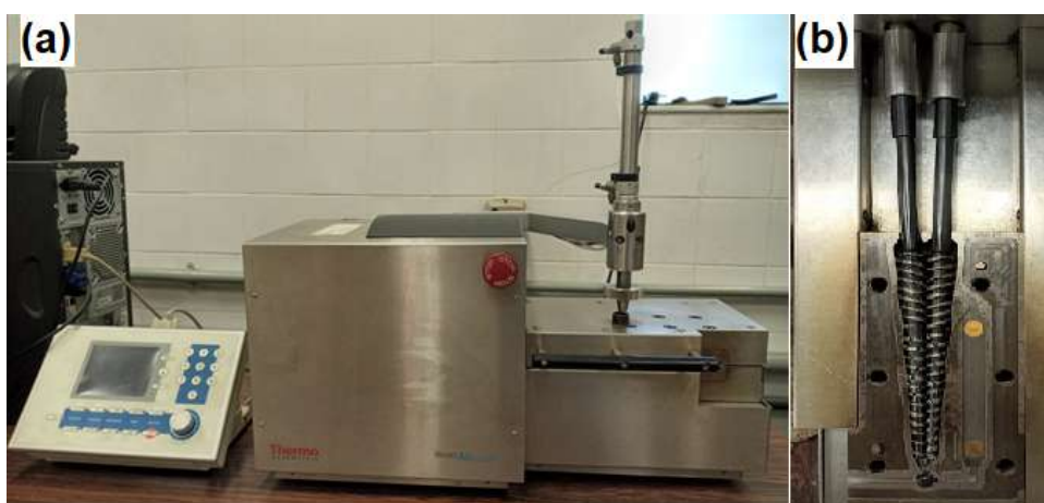
Figura 3.3 – (a) Extrusora de bancada utilizada para o processamento do polímero e dos nanocompósitos; (b) dupla rosca contra-rotante.
