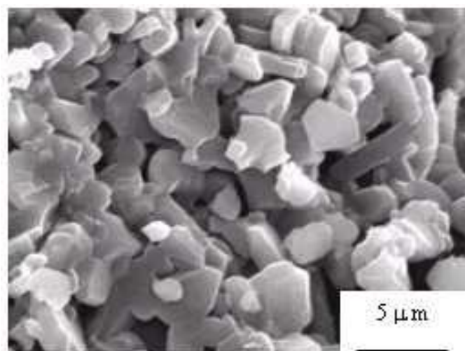
FIGURA 5.7: Superfície de fratura dinâmica da amostra #11. Predominância de fratura intergranular.
