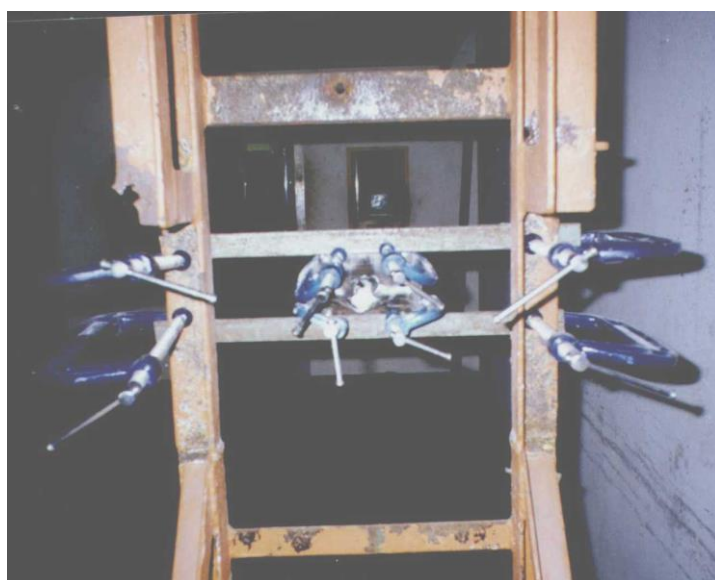
FIGURA 3.7: Alvo fixado no cavalete após o impacto do projétil.
