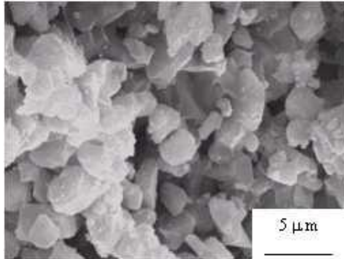
FIGURA 5.15 : Superfície de fratura dinâmica da amostra #7. Predominância de fratura intergranular. Baixo tamanho de grão.
